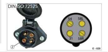
Tab. 3 Pos. 1) plug / Pos. 2) socket
