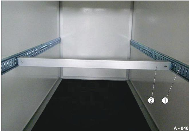
**Abb. 40** Beispiel: Teleskop-Sperrbalken (Fahrstellung)
