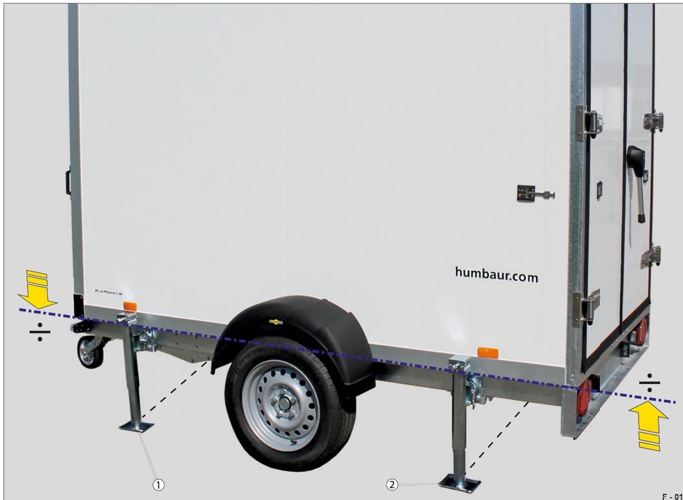
**Abb. 10** Kühlkoffer 4 - seitig abgestützt, horizontal ausgeglichen
