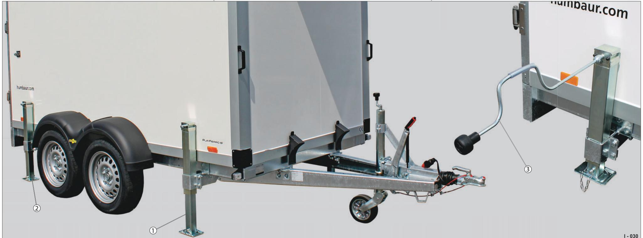
**Abb. 34** Cooler / Tiefkühler mit 4 stabilen Teleskop-Kurbelstützen
