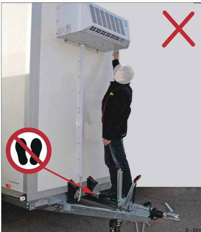
Abb. 1 Arbeitshöhe des Kühlaggregats
