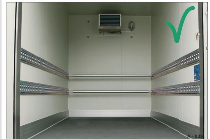
**Abb. 39** Sperrstangen gesichert (Fahrstellung)
