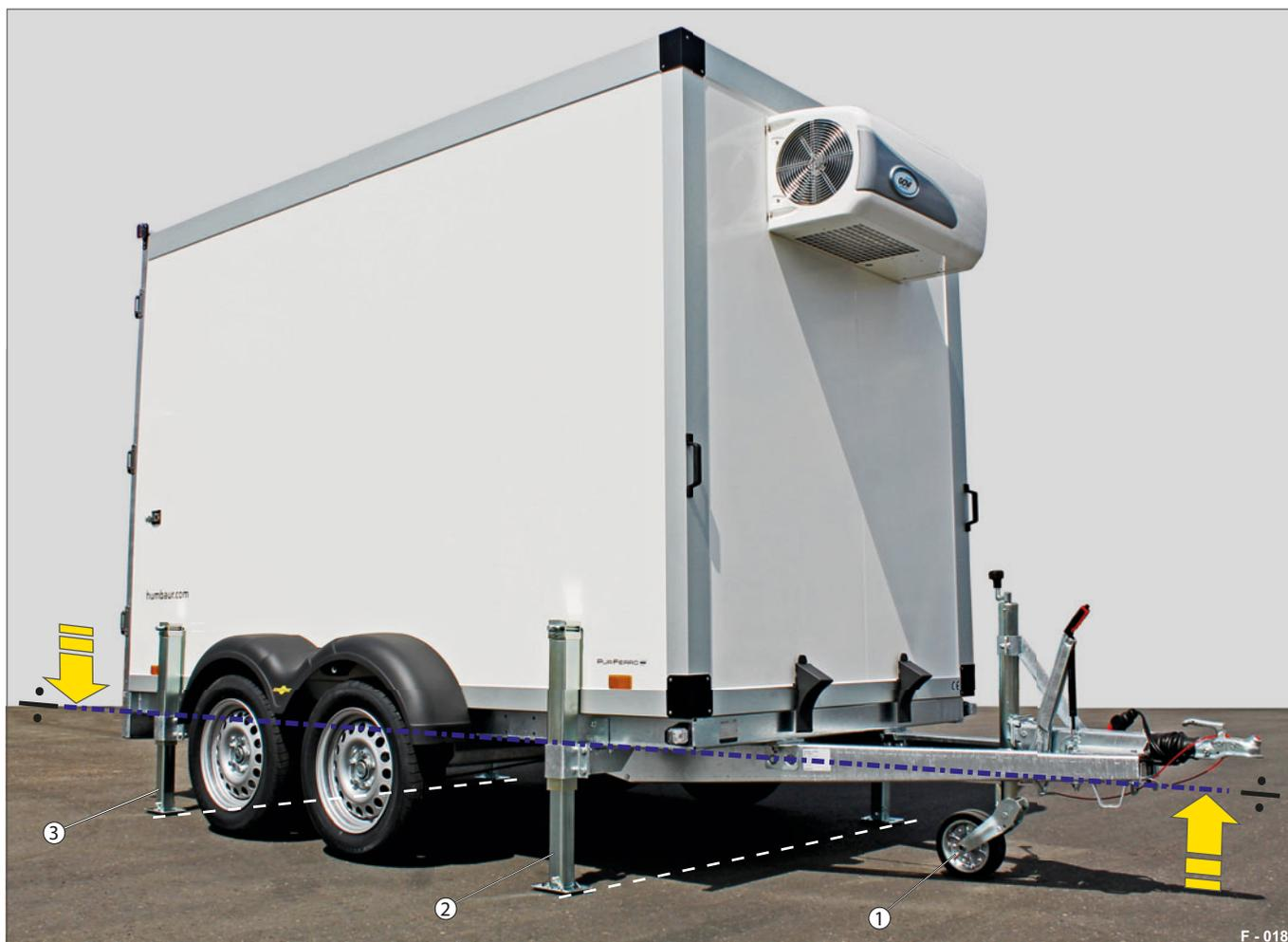
Abb. 17 Kühlkoffer 4 - seitig abgestützt, horizontal ausgeglichen
