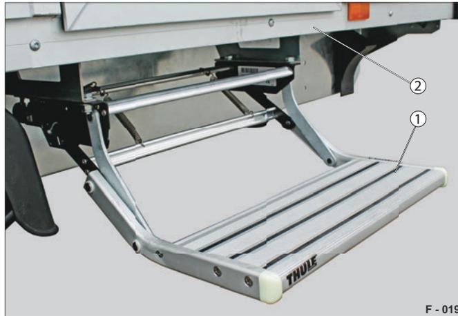
Abb. 18 Trittstufe ausgeschwenkt
