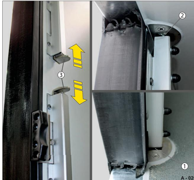
**Abb. 26** Türflügel-Verriegelung verriegelt
