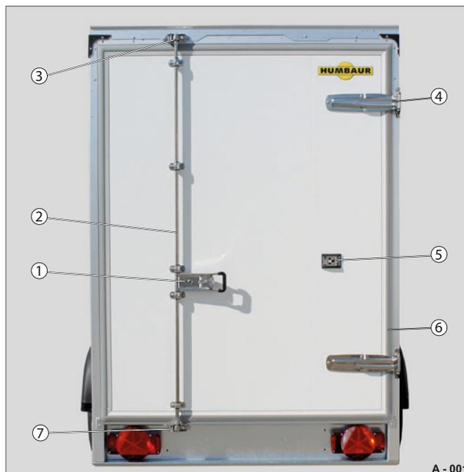
**Abb. 1** Rückwand-Portaltüre einflügelig (geschlossen in Fahrstellung)
