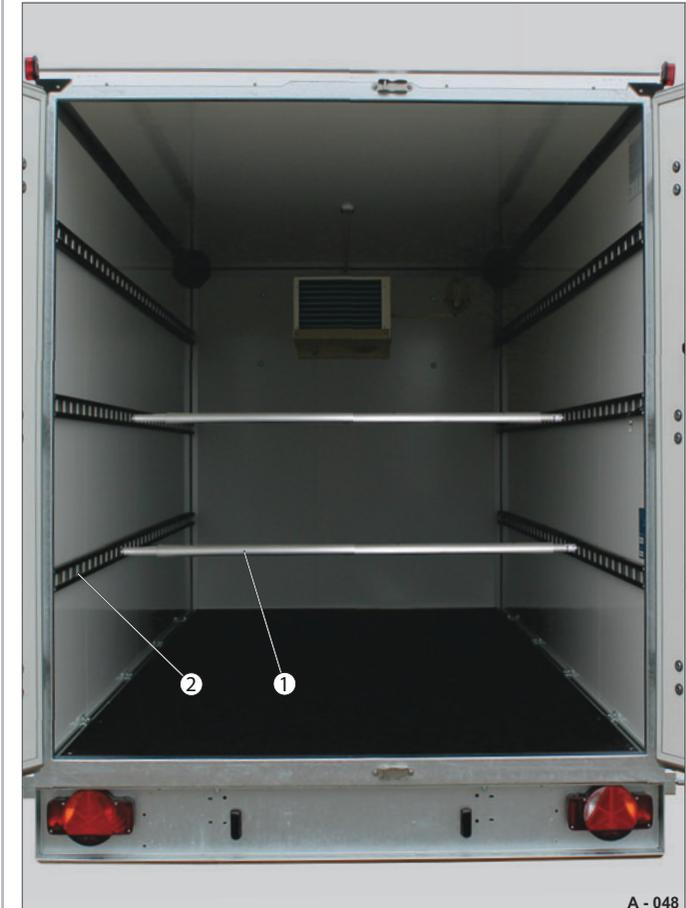
**Abb. 48** Sperrstangen gesichert (Fahrstellung)
