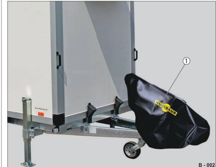
**Abb. 6** Auflaufeinrichtung / Kupplung abgedeckt
