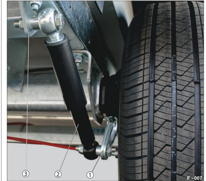
Abb. 6 Radstoßdämpfer eingebaut
