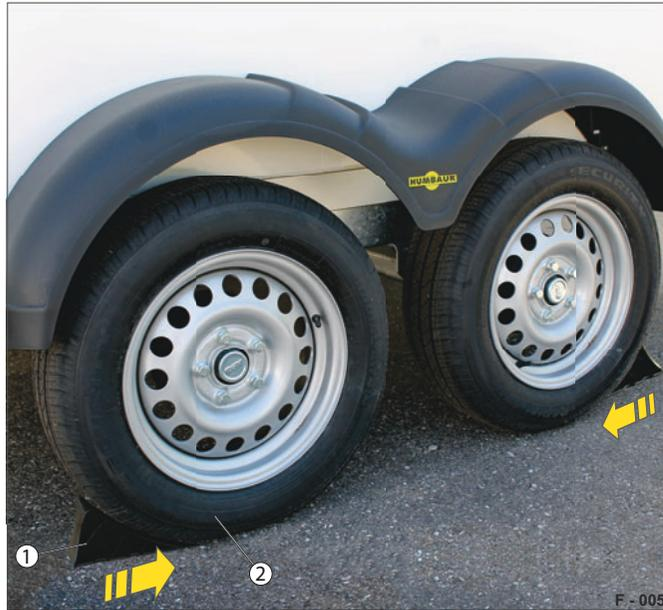
Abb. 4 Unterlegkeile untergelegt in Parkstellung
