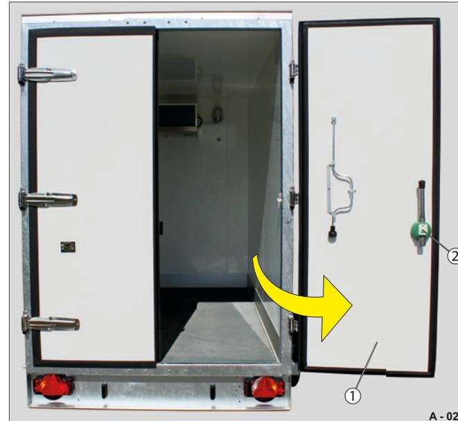
**Abb. 20** Türflügel rechts öffnen
