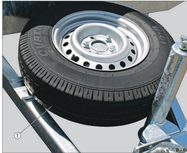
**Abb. 5** Beispiel: Ersatzrad auf der langen Zugdeichsel
