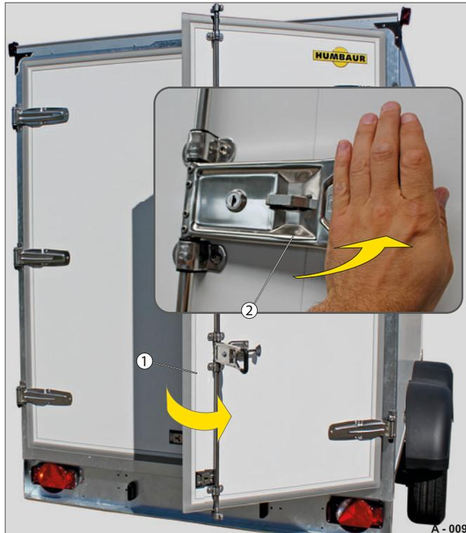
Abb. 9 Drehstangen-Verschluss schließen
