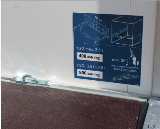
**Abb. 21** 4 Stück je Seite in Bodenschiene integriert
