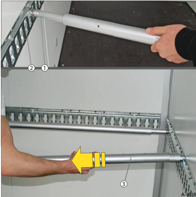
**Abb. 36** Sperrstange positionieren
