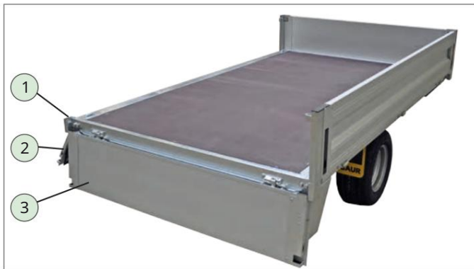
Bočne stijenke sklopljene / kutni stupić isključen
