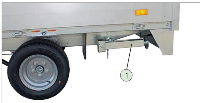
HN / HU - s teleskopskim nosačima vretena
