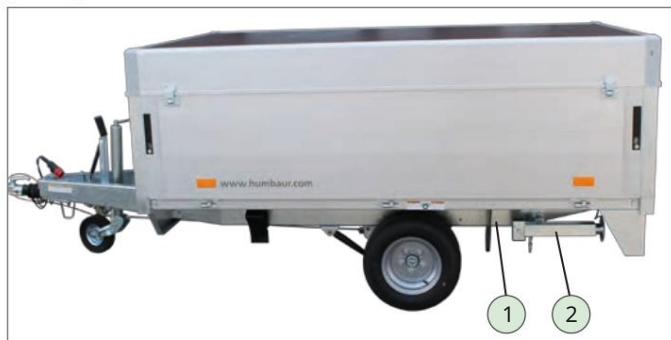
Teleskopski nosači radilice, okretni
