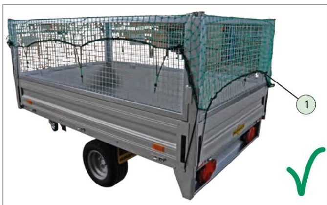
Osigurano zaštitnom mrežom
