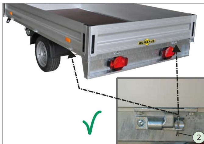
Montirajte/učvrstite bočnu stijenu baze
