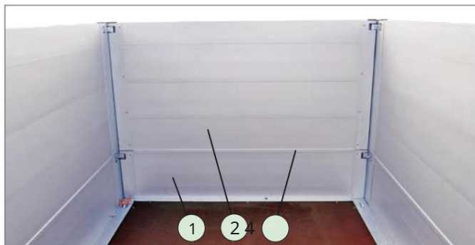
Pričvršćivanje bočnog zida pričvršćeno / zatvoreno
