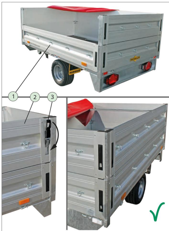
Pričvrstite/zatvorite dodatak za bočni zid
