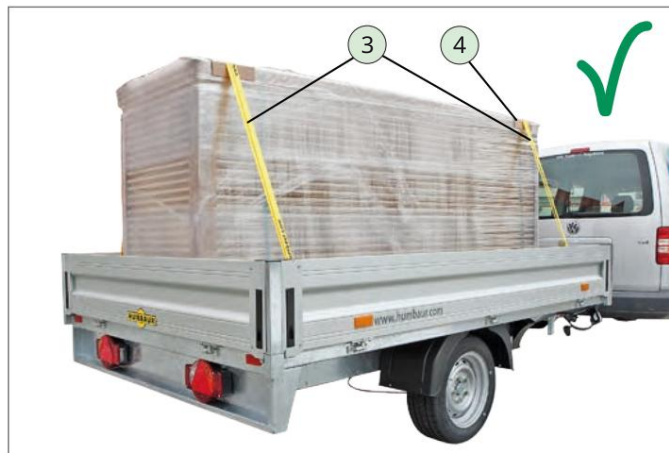
Osigurano pravilnim prijanjanjem i pričvršćivanjem
