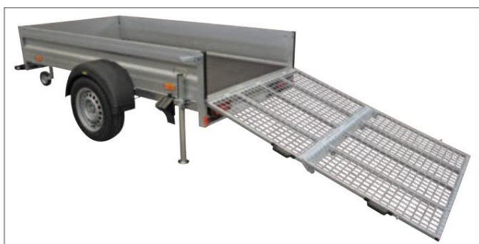
HA með rampvegg (stálgrind) - lækkað
