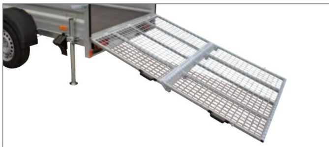
Rampveggur með rist - sem slétt aðgengisyfirborð
