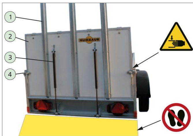
Drveni zid rampe, zatvoren (vozački polož aj)
