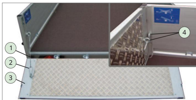
Stražnji bočni zid osiguran
