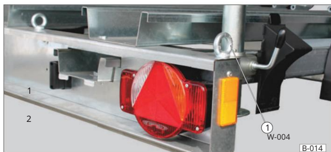
Sl. 14 Stražnje točke za pričvršćivanje
