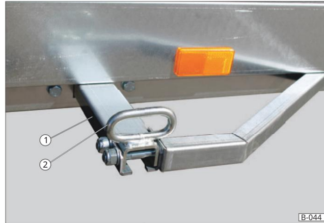
Sl. 20 Prednje točke za pričvršćivanje 1 Poprečni nosač na okviru 2 Ušice za pričvršćivanje, pričvršćene vijcima
