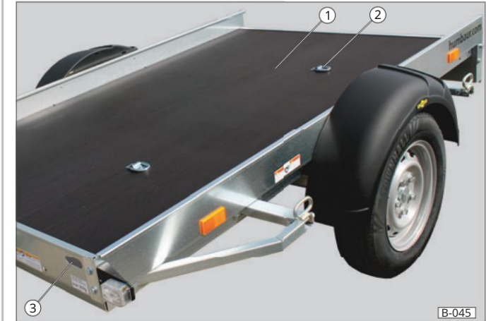
Sl. 21 Točke za pričvršćivanje na utovarnom prostoru (opcionally) 1 utovarni prostor 2 ušice za pričvršćivanje, pričvršćene vijcima 3 utora za tethering
