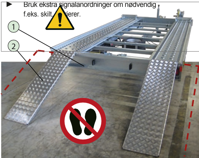
Oppkjøringsplanker plassert for lossing
