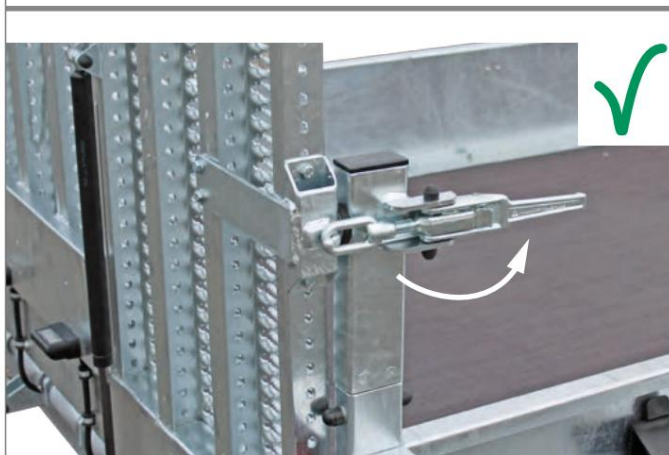
Zid rampe zatvoren i osiguran
