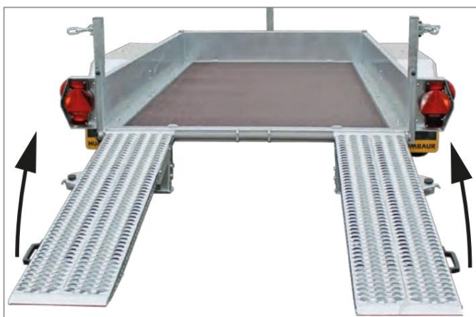
Zatvorite pristupne rampe
