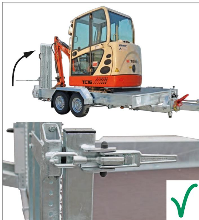
Pristupna rampa zatvorena i osigurana
