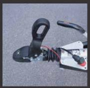
Sicherheitskupplung mit Spurstabilisierung
