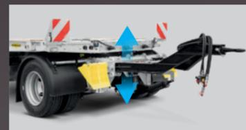
Die Zugdeichsel lässt sich in drei Standardhöhen einstellen und somit optimal an unterschiedlichen Zugfahrzeugen anbringen.
