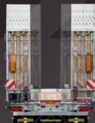
Verschiedene Auffahrbreiten sofort einstellen, mechanisch oder optional hydraulisch
