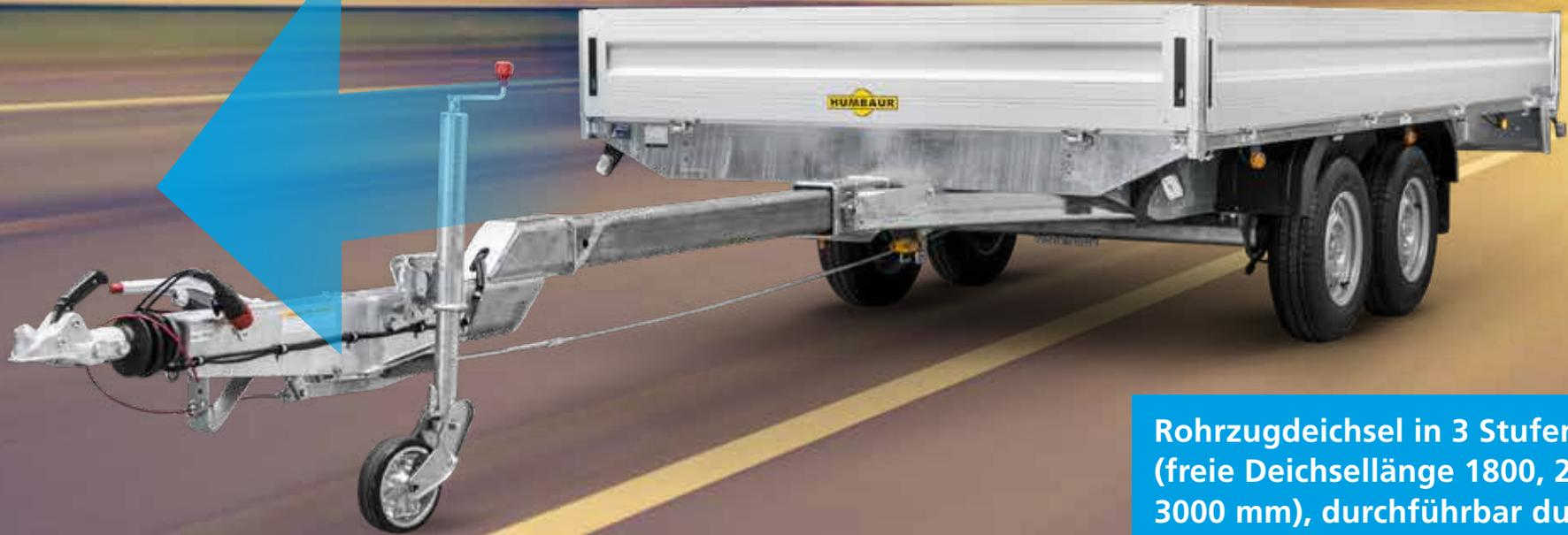
Rohrzugdeichsel in 3 Stufen ausziehbar (freie Deichsellänge 1800, 2350 und 3000 mm), durchführbar durch eine Person, kein Werkzeug benötigt.
