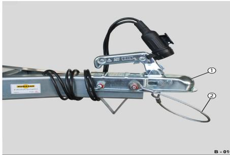
**Abb. 9** Beispiel: Ungebremste Anhänger bis 750 kg GG
