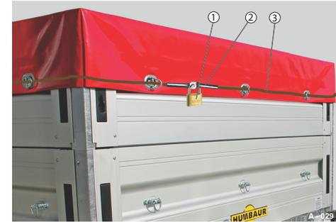
Abb. 60 Zollseilsicherung als Diebstahlschutz
