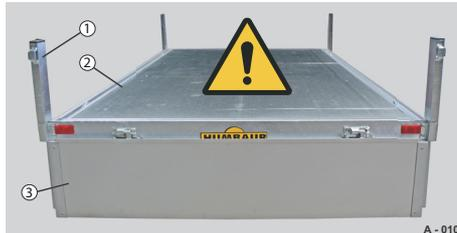
Abb. 2 Ungesicherte Bordwände / Eckrungen
