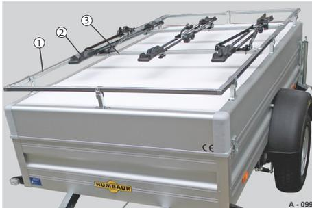
Abb. 95 Fahrradträger, montiert
