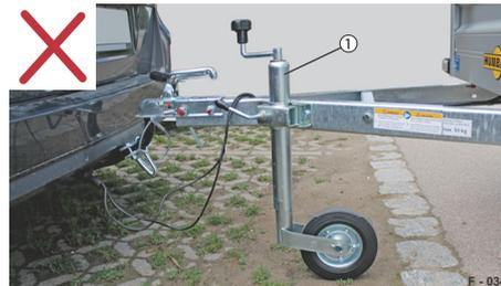
Abb. 7 Stützrad, Stützstellung falsch
