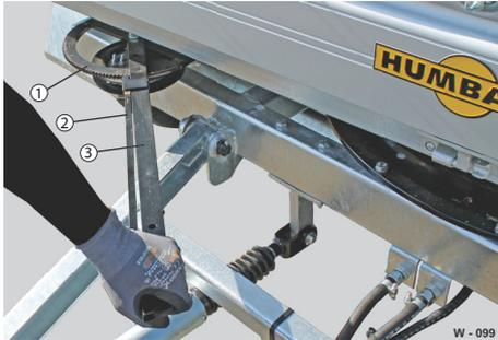
Abb. 57 Drehkranzbremse, Schmierstelle
