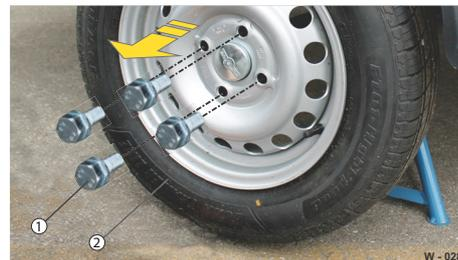
Abb. 30 Defektes Rad abziehen
