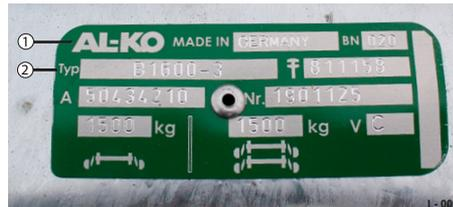
Abb. 25 Beispiel: Typenschild AL-KO-Achse, gebremst
