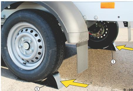
Abb. 82 Unterlegkeile, untergelegt
