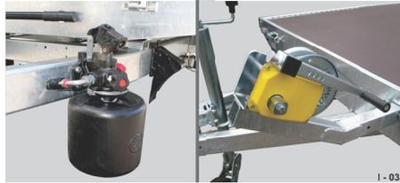
**Abb. 44** Hydraulikanlage / Seilwinde
