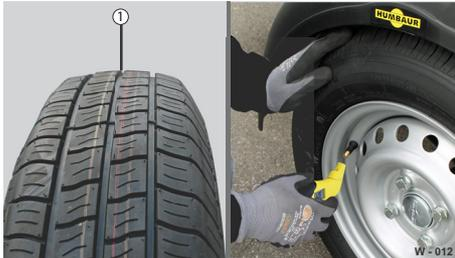
Abb. 14 Reifenfülldruck kontrollieren
