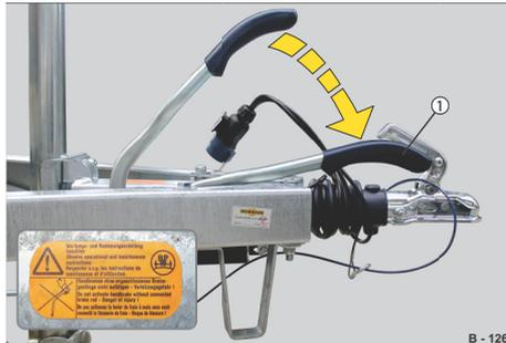
**Abb. 86** Beispiel 2: Handbremse gelöst, BPW
