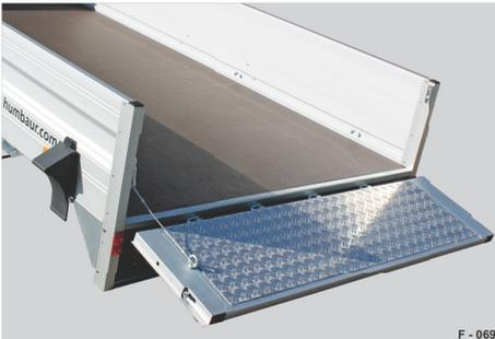
**Abb. 72** Beispiel 6: Überfahrklappe**⚠️ WARNUNG****Auffahrhilfen überbelasten!**
