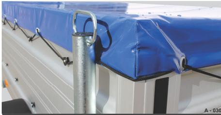
Abb. 52 Eckenausführung: Expanderseil
