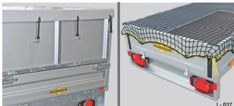
**Abb. 47** Flachplane auf Aufbauten / Abdecknetz
