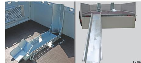
**Abb. 55** Motorradständer / Motorrad-Auffahrschiene
