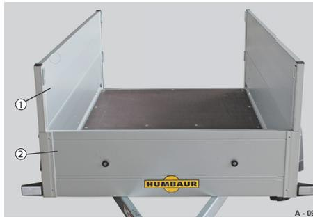
**Abb. 26** Heckbordwand / Bordwandaufsatz, demontiert
