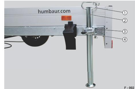
**Abb. 25** Schiebestützen, Stützstellung
