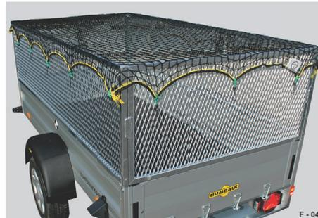
Abb. 102 Beispiel: Stahlgitteraufsatz
