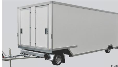
**Abb. 57** Beispiel: 2-Achser als Kofferaufbau, Plywood
