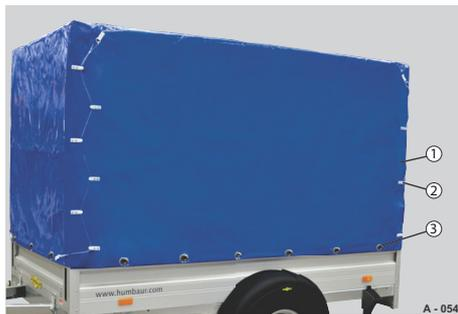
**Abb. 61** Sicherung mit Schleuderseil / Krampen
