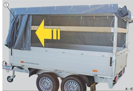
**Abb. 85** Rückwand / Schiebeplane geöffnet
