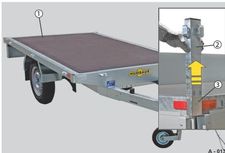
**Abb. 14** Bordwände demontiert, Eckrungen ausgesteckt
