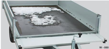
Abb. 89 Holzladefläche / Mehrschichtholzplatte
