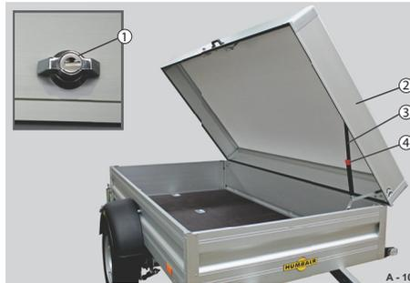
Abb. 93 Deckel, seitlich befestigt
