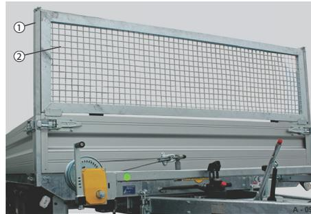
Abb. 29 Stahlgitterausatz
