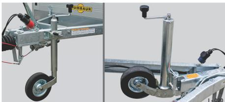
Abb. 36 Stützrad / Automatik-Stützrad
