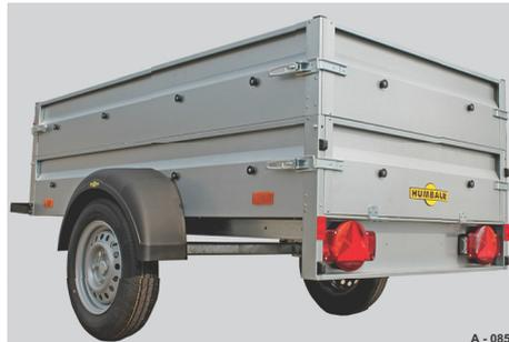
**Abb. 20** Bordwandaufsatz, z.B. bei STEELY
