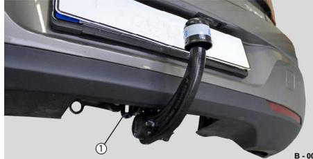
**Abb. 3** Beispiel 3, abnehmbare Kupplung, Öse am Träger
