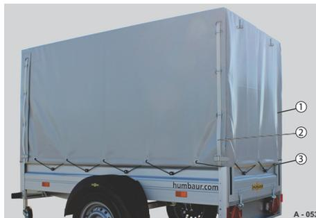
**Abb. 62** Sicherung mit Riemenband / Expanderseil
