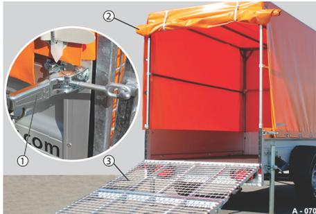
**Abb. 82** Hochplane geöffnet, Überfahrwand abgeklappt
