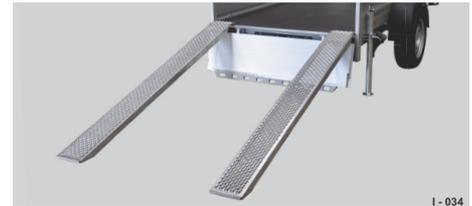
**Abb. 46** Auffahrbohlen / -schienen
