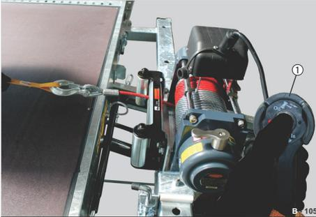
**Abb. 46** Beispiel 2: Seilwinde mit Fernbedienung
