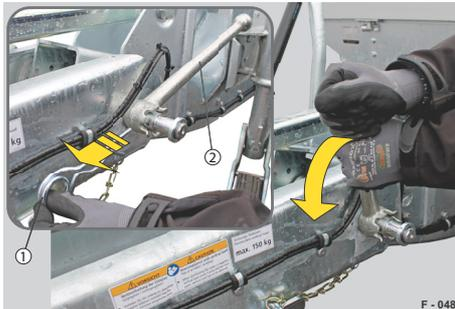
**Abb. 46** Feststellknebel lösen
