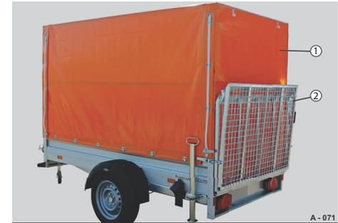
**Abb. 83** Hochplane geschlossen, Fahrstellung
