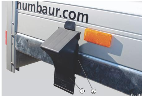
**Abb. 77** Beispiel 1: Unterlegkeile senkrecht, seitlich
