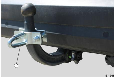
**Abb. 5** Beispiel: Klemmvorrichtung, Kupplung
