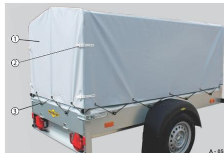
**Abb. 63** Sicherung Schnalle / Expanderseil
