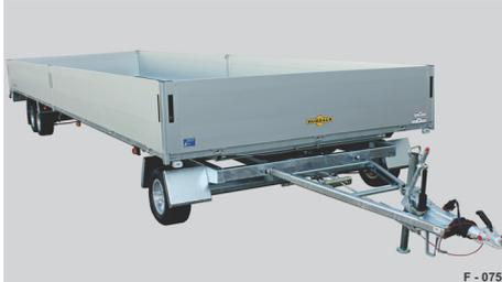
**Abb. 56** Beispiel: 3-Achser als Kastenaufbau
