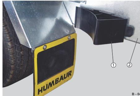
**Abb. 78** Beispiel 2: Unterlegkeile waagrecht, seitlich
