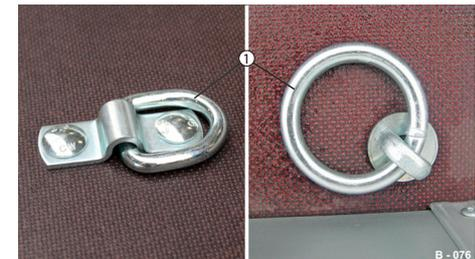
Abb. 60 Zurropunkte aufliegend, optional (Zurrkraft = max. 200 daN (kg))
