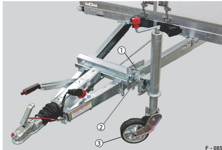
Abb. 5 Beispiel: Automatik-Stützrad, schwenkbar
