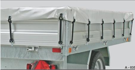
Abb. 56 Eckenausführung: Spannseil mit Haken
