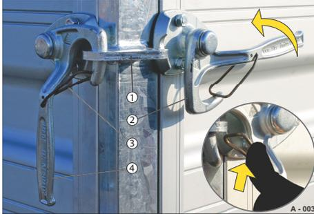
**Abb. 8** Winkelhebelverschluss, HTK, HT, Koffer, Pferd
