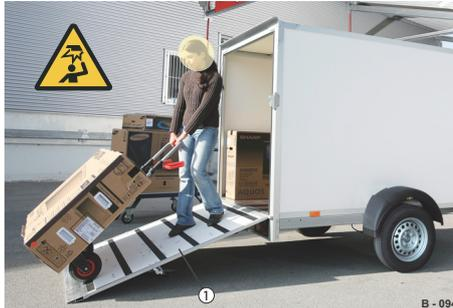
Abb. 35 Überfahrwand bedienen
