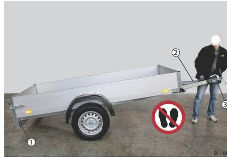
Abb. 72 Rangieren mit ungebremstem Anhänger
