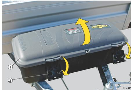
Abb. 79 Werkzeugkasten entriegeln
