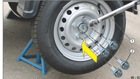
**Abb. 32** Ersatzrad montieren
