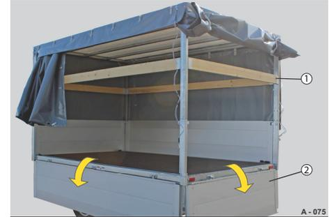
**Abb. 86** Bordwände, abgeklappt
