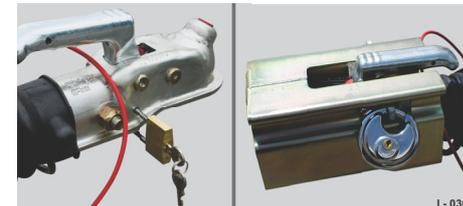
Abb. 39 Bügelschloss / Metallabsperrschuh
