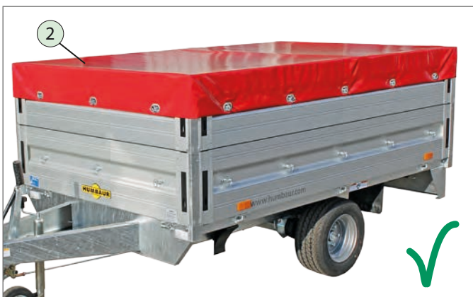
Sécurisée avec une bâche plate
