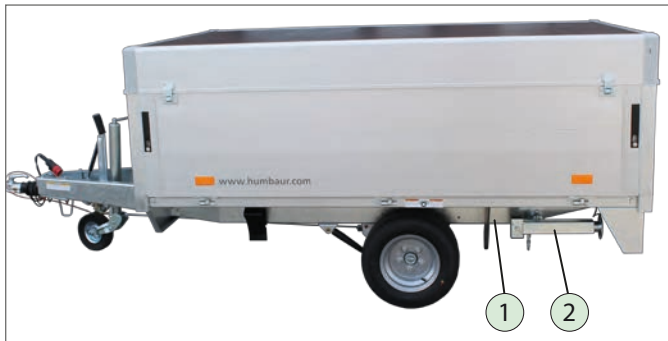
Béquilles télescopiques à manivelle, orientables
