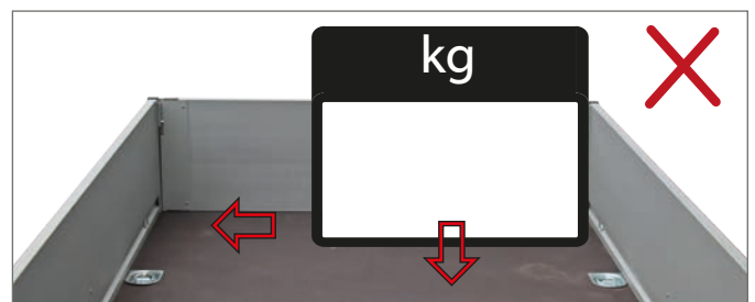
Chargement réparti incorrectement
