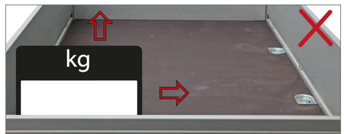
Chargement réparti incorrectement
