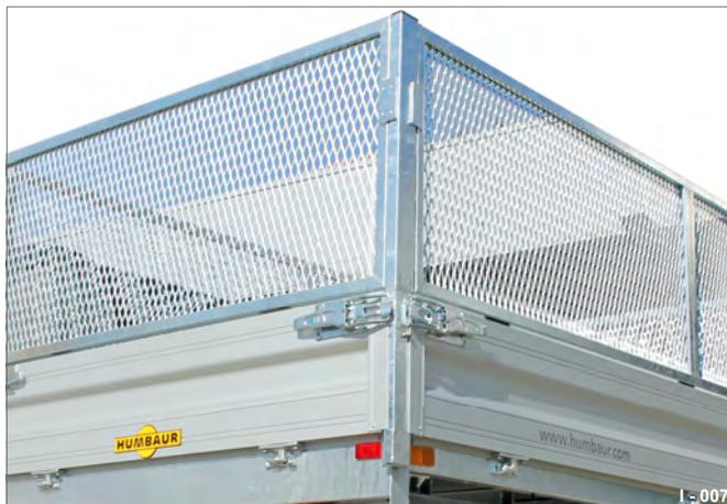
Fig. 7 Accrochée dans des montants d'angle
