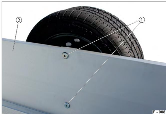
**Fig. 6** Support pour roue de secours, intérieur
