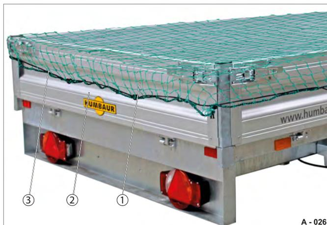
Fig. 41 Filet de couverture, monté
