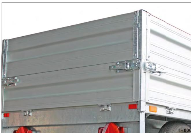
Fig. 6 Accrochée dans des montants d'angle
