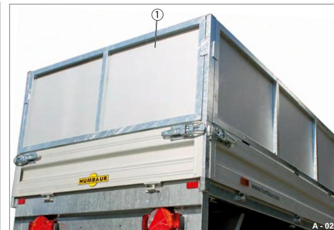
**Fig. 27** Rehausse en aluminium, quadrilatérale
