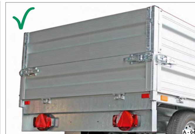
**Fig. 37** Ridelle arrière / rehausse de ridelles en position de conduite
