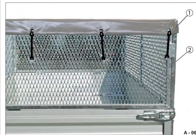
**Fig. 54** Bâche plate (en cas de rehausse grillagée en acier)
