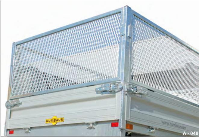
Fig. 38 Rehausse grillagée en acier, position de conduite
