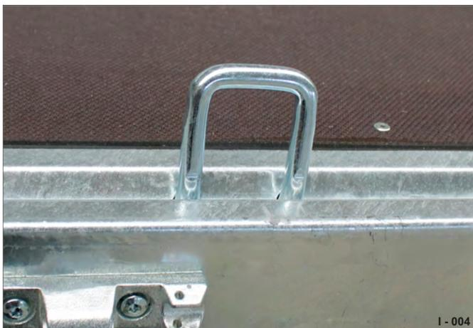
Fig. 4 Étrier d'arrimage, escamotable
