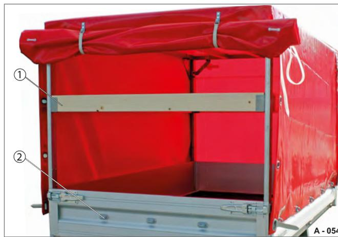
Fig. 56 Bâche haute, ouverte à l'arrière
