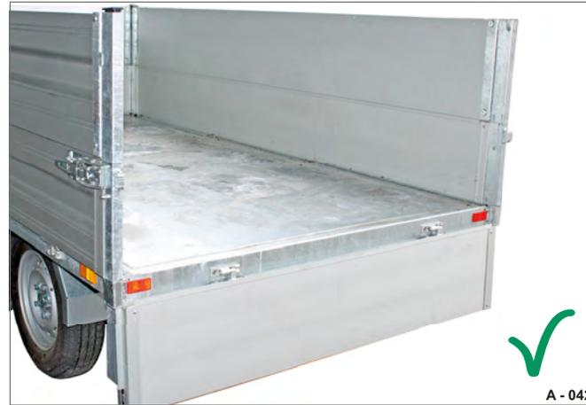
**Fig. 33** Rehausse de ridelles démontée
