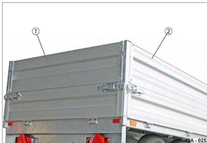
**Fig. 25** Rehausse de ridelles, quadrilatérale
