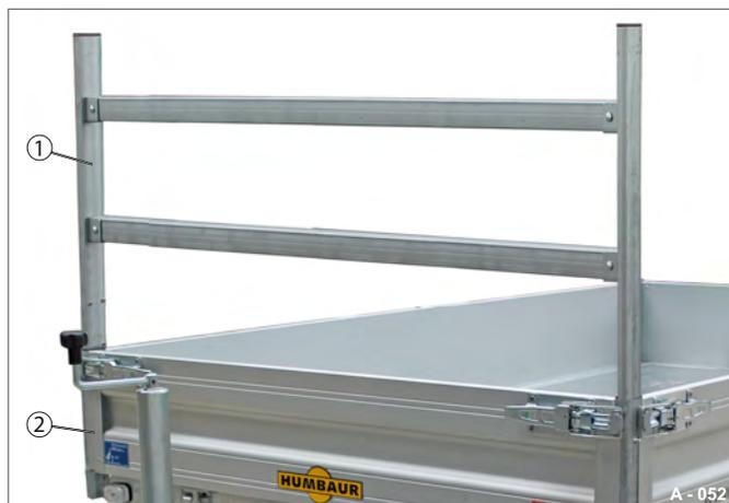
Fig. 59 Bâti en H monté
