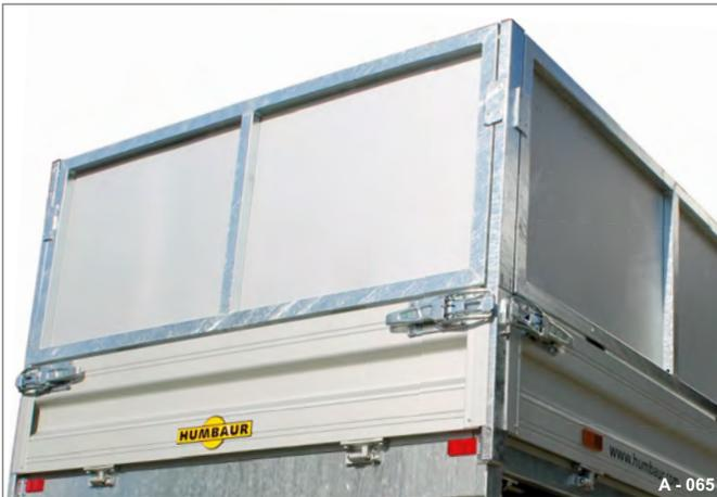
Fig. 39 Rehausse en aluminium, position de conduite
