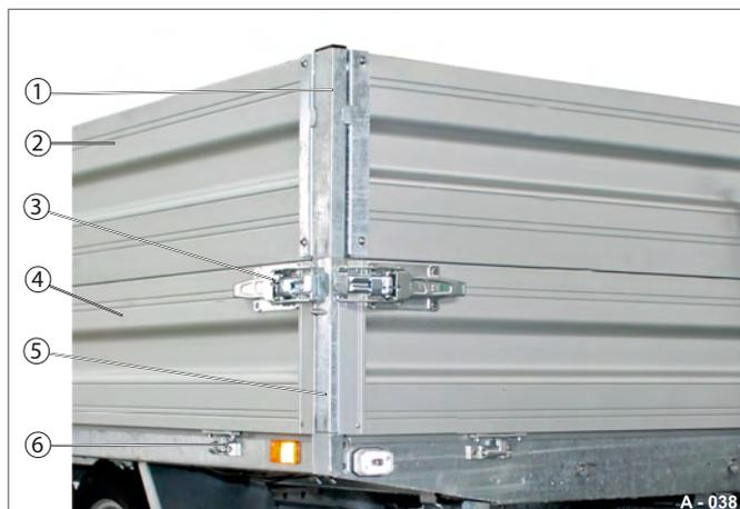
Fig. 29 Rehausse de ridelles montée
