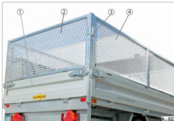
**Fig. 26** Rehausse grillagée en acier, quadrilatérale
