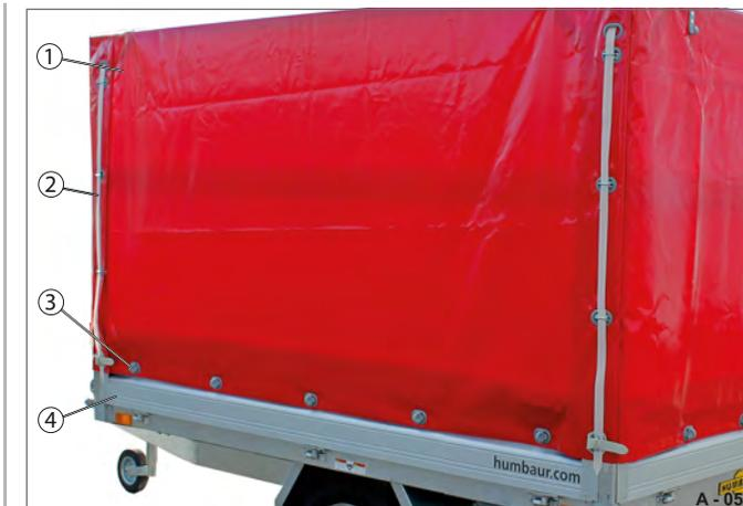
Fig. 58 Bâche haute, bloquée (position de conduite)
