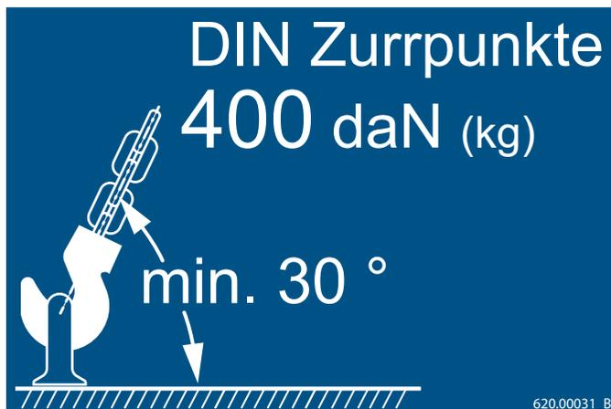
Fig. 62 Autocollant relatif aux points d'arrimage
