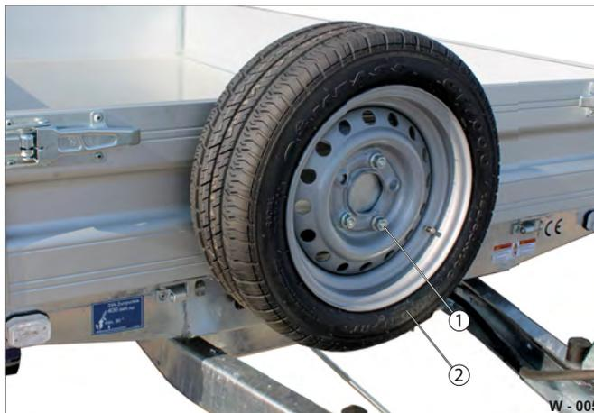
**Fig. 4** Contrôle du support pour roue de secours
