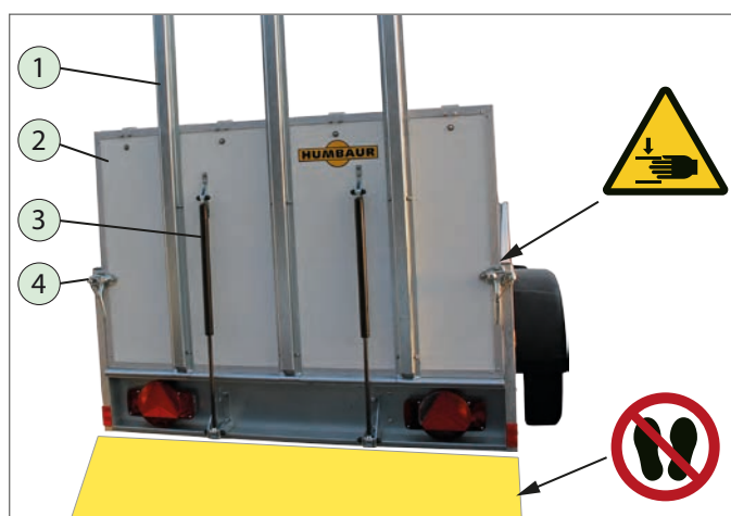
Pont arrière en bois, fermé (position de déplacement)
