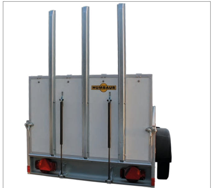
HA avec pont arrière (bois) - bloqué
