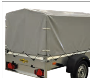
Bâche haute / arceaux
