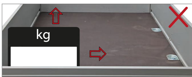
Chargement réparti incorrectement
