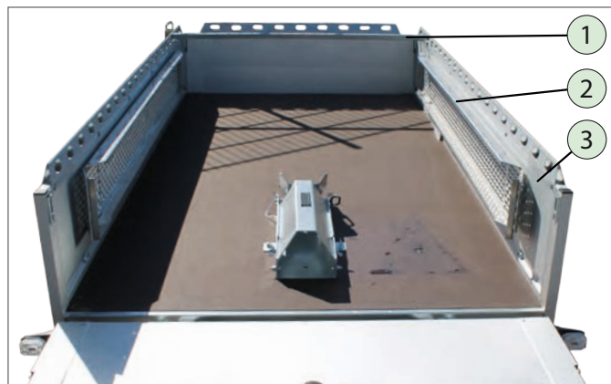
Rampes de chargement bloquées sur les ridelles (position de conduite)
