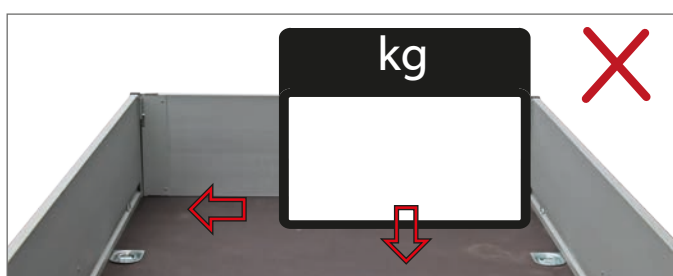
Chargement réparti incorrectement
