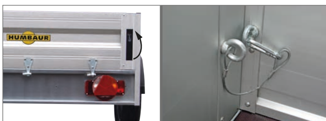
Ouverture / fermeture des fermetures à excentrique
