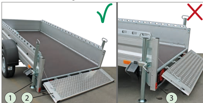
Surface de chargement basculée avec béquilles réglables
