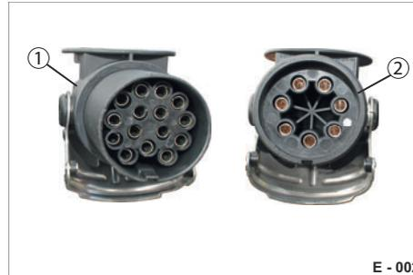
**Abb. 5** Steckverbindungen, 24 V-Standard
