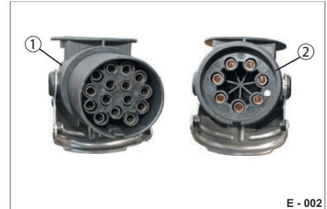
**Abb. 3** Steckverbindungen, Standard 24 V
