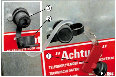
**Abb. 36** Elektro-Hydraulik abgeschaltet
