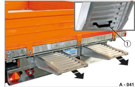
**Abb. 51** Auffahrbohlen herausziehen
