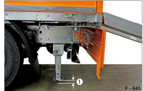
**Abb. 53** Klappstütze abgeklappt
