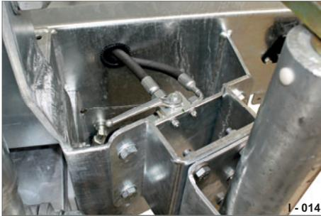
Abb. 15 Umschalthebel Hydraulikversorgung
