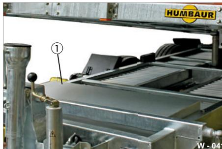
**Abb. 30** Elektro-Hydraulik-Aggregat, geschlossen
