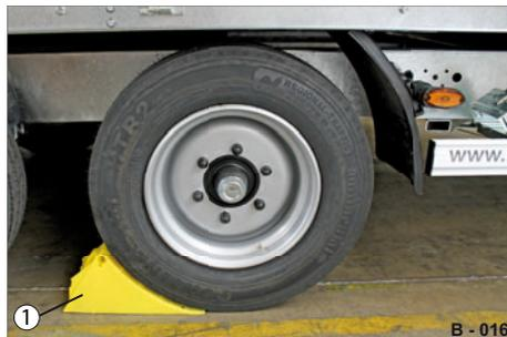
**Abb. 67** Unterlegkeile untergelegt
