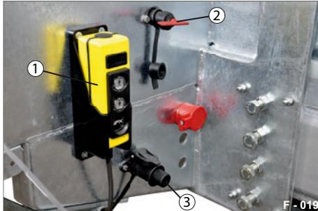
**Abb. 32** Bedienstelle Elektro-Hydraulik
