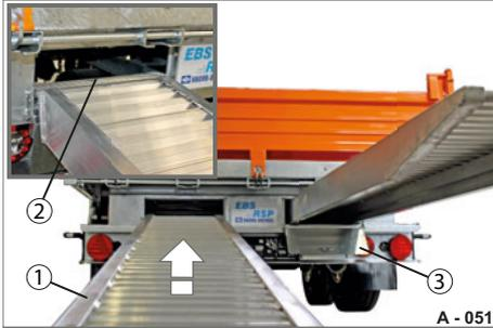
**Abb. 61** Auffahrbohlen einschieben
