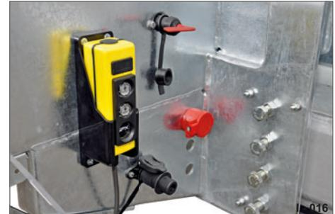
Abb. 14 Taster und Hauptschalter für Kippvorgang
