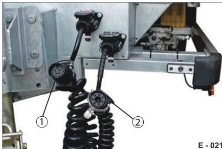
**Abb. 4** Verbindungskabel 12 V bzw. 24 V
