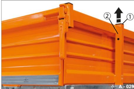
**Abb. 42** Montage Stirn-Stahlgitteraufsatz vorbereiten
