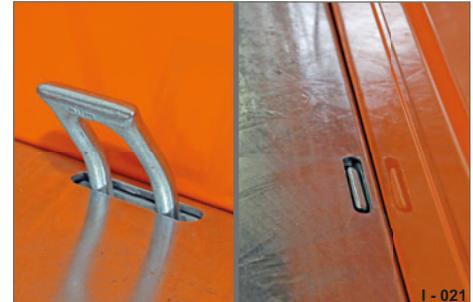
Abb. 26 Zurrbügel, versenkbar
