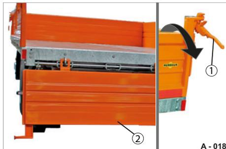
Abb. 20 Heck-Bordwand abgeklappt
