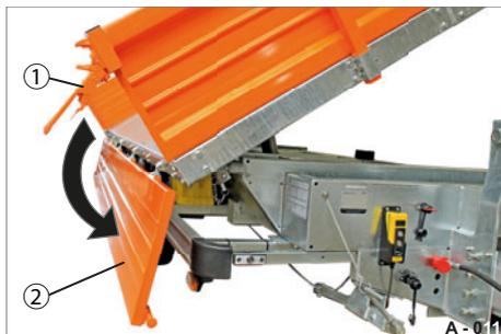
**Abb. 11** Bordwand abgeklappt
