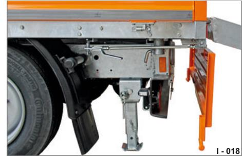
Abb. 25 Klappstützen am Heck
