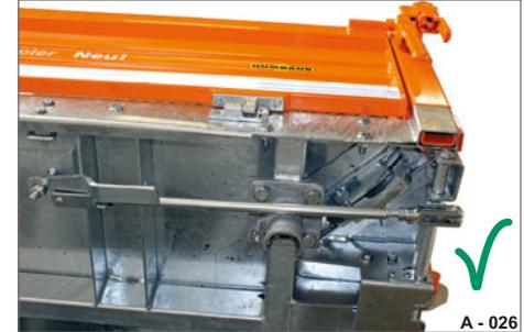
**Abb. 27** Zentralverriegelung geschlossen
