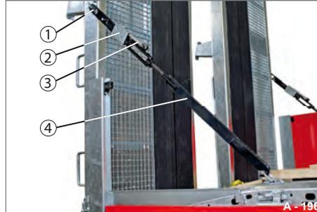
**Abb. 38** Auffahrrampen mit Sicherungsspanner 2
