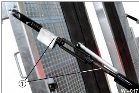
**Abb. 20** Sicherungsspanner 2, schmieren
