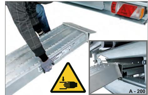
Abb. 8 Auffahrbohlen herausheben
