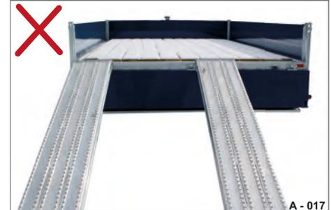
**Abb. 22** Auffahrbohlen - nicht proportional positioniert
