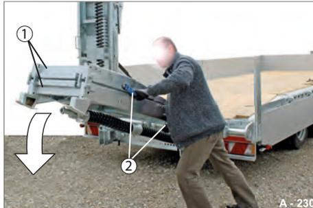
**Abb. 94** Auffahrrampe ablassen
