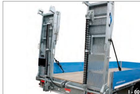
Abb. 8 1/3 Teilung, mit Federhebewerk
