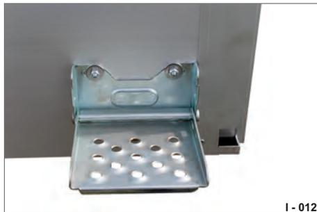
**Abb. 14** Klaptritt an der Heckbordwand
