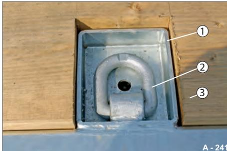
**Abb. 145** Zurring, eingeklappt
