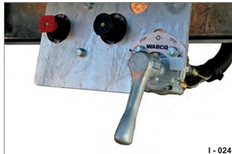
Abb. 25 Bedienstelle am Heck, für Höhenangleichung des Fahrgestells
