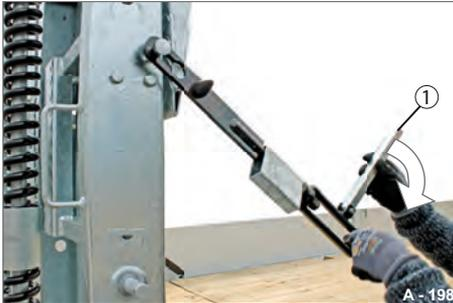
Abb. 51 Sicherungsspanner entspannen
