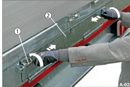
**Abb. 29** Auffahrbohlen-Schacht entriegeln
