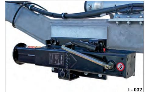
Abb. 34 An Rohrzugdeichsel montiert
