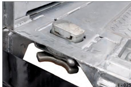
Abb. 26 Container-Verriegelung „Twist-Lock“
