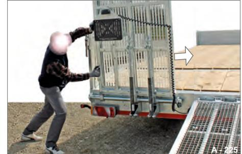
**Abb. 79** Spurweite einstellen
