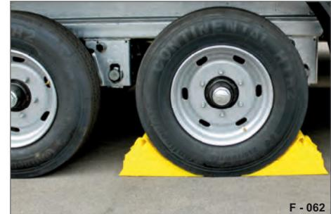
Abb. 88 Beispiel: Unterlegkeile, untergelegt
