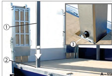
**Abb. 171** Steckung einsetzen
