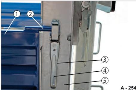
**Abb. 117** Bordwand-Verschluss, GESCHLOSSEN
