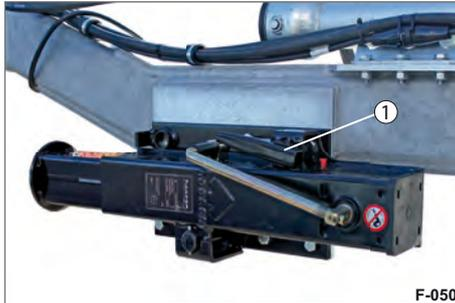
Abb. 52 Schwenkstütze / Fahrstellung
