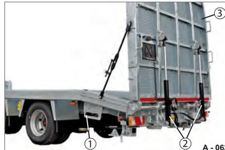
**Abb. 101** Überfahrwand, hydraulisch
