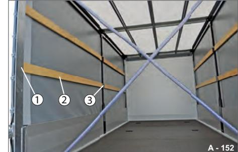
**Abb. 211** Einstecklatten, eingesteckt
