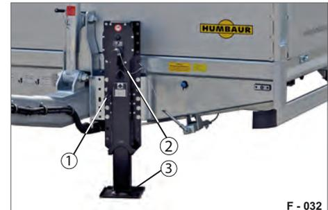
Abb. 47 Getriebestützwinde
