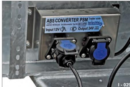
Abb. 32 Spannungswandler (12 V - 24 V)
