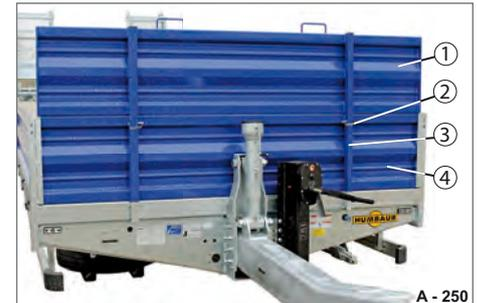
Abb. 185 Bordwandaufsatz aus Stahl
