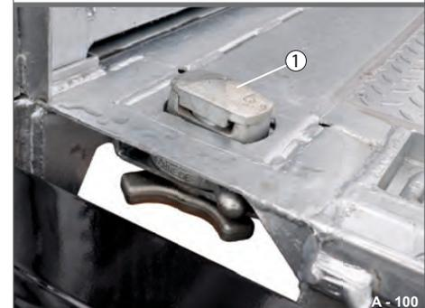
Abb. 153 Container-Verriegelung
