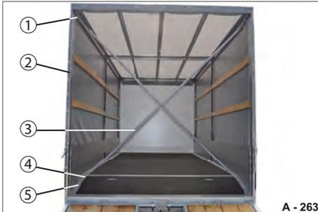
**Abb. 205** Diagonal-Verspannung
