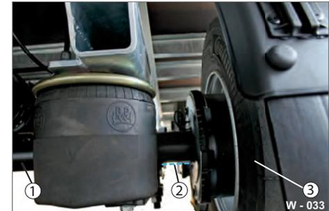
Abb. 38 Hebevorrichtung ansetzen
