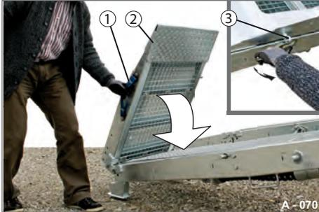
**Abb. 107** Auffahrrampe zweiteilig anheben
