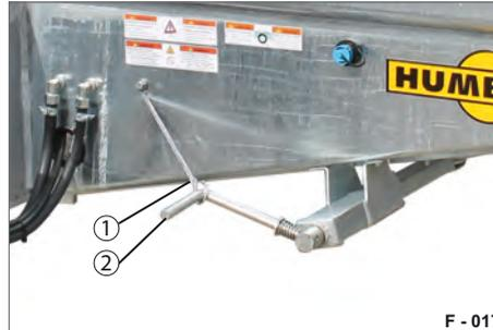
**Abb. 19** Spindel-Feststellbremse, gesichert
