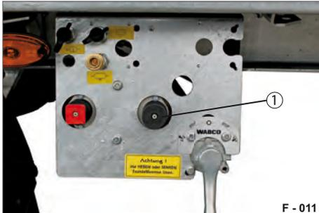
**Abb. 13** Betriebsbremse lösen
