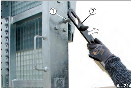
Abb. 52 Sicherungsspanner entnehmen
