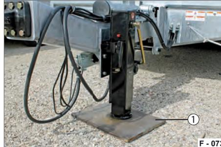
Abb. 46 Stützfuß, stabilisiert
