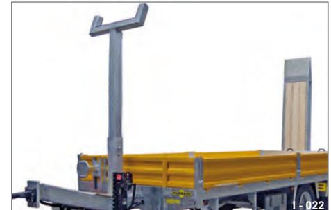
Abb. 22 Auf der Rohrzugdeichsel montiert
