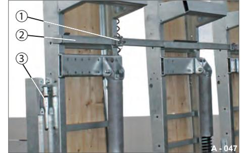
**Abb. 42** Drei Auffharrampen mit Sicherungsverchluss und Gestänge
