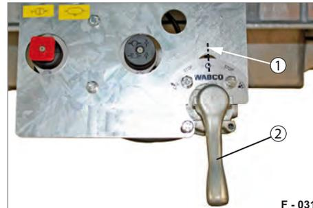
Abb. 31 Schwenkhebel in Fahrstellung
