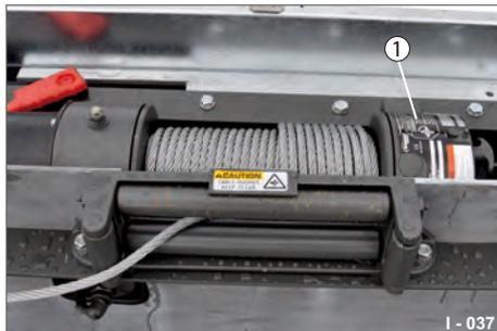
**Abb. 40** Seilwinde
