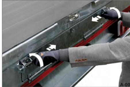
Abb. 6 Auffahrbohlen-Schacht, Öffnen
