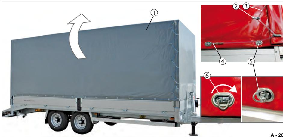
Abb. 207 Seitlichen Planenteil bedienen
