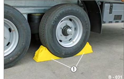
**Abb. 36** Unterlegkeile, angelegt
