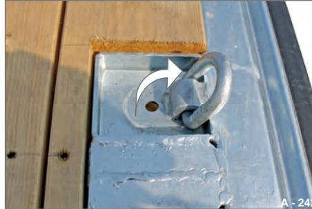
**Abb. 146** Zurring, ausgeklappt
