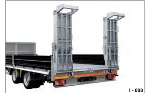
Abb. 10 1/2 Teilung, mit Gasdruckfedern
