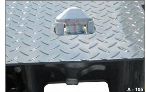
Abb. 158 Verriegelung in Aufnahmestellung
