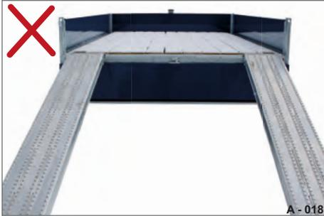
**Abb. 23** Auffahrbohlen - zu weit nach außen
