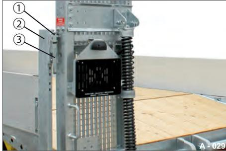
**Abb. 40** Auffharrampen mit Sicherungsverchluss
