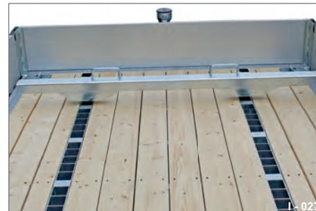
Abb. 28 Sicherungsschiene als Radanschlag
