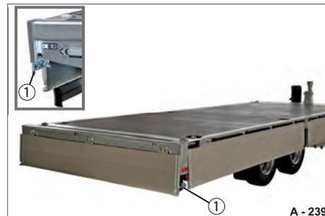
**Abb. 125** Bordwände, rundum abgeklappt
