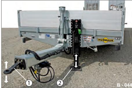
**Abb. 37** Höhenangleichung / Ausrichtung
