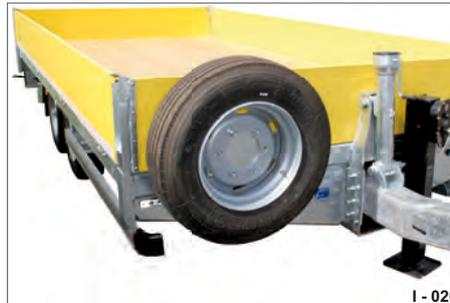
Abb. 20 Halterung an der Stirnbordwand
