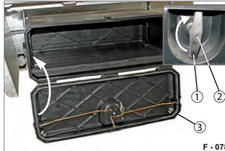
**Abb. 107** Werkzeugkasten verschließen
