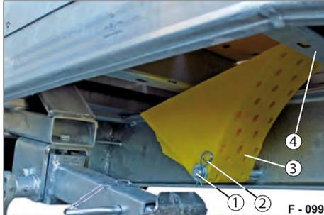
**Abb. 92** Unterlegkeil heckseitig, unter Fahrgestell geparkt
