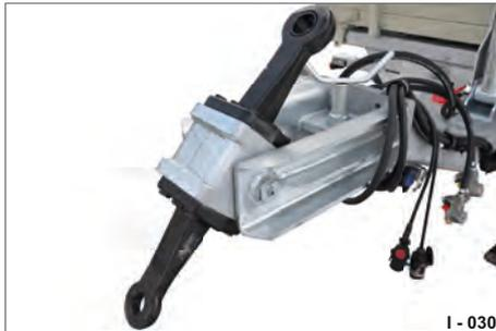
Abb. 30 Schwenkzugöse D 40 mm / 50 mm
