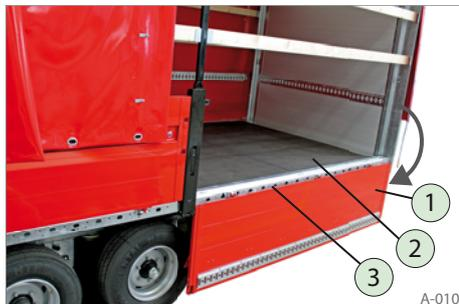
**Abb. 10** Bordwand abgeklappt
