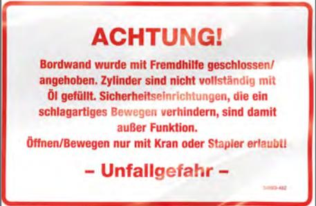
Abb. 5 Warnschild defekte Ladebordwand
