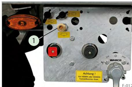
**Abb. 16** Luftanschluss für Druckluftsystem
