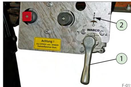
Abb. 18 Schwenkhebel in Fahrstellung
