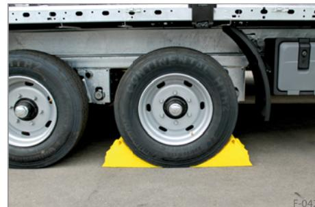
Abb. 44 Unterlegkeile untergelegt
