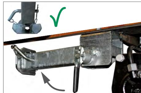
**Abb. 24** Klappstütze in Fahrstellung
