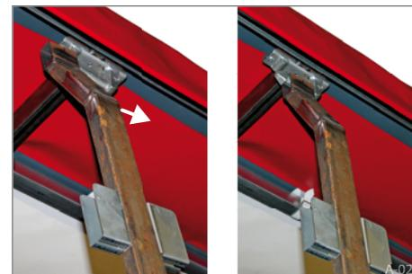
**Abb. 23** Standrohr einhängen
