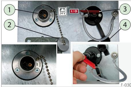
**Abb. 31** Ladeanschluss (DIN 14690)
