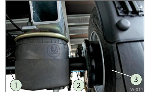
**Abb. 12** Hebevorrichtung ansetzen
