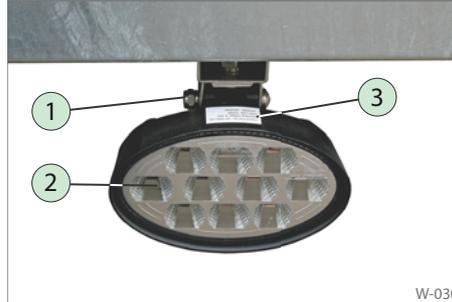
**Abb. 33** Arbeitsleuchte außen am Heck
