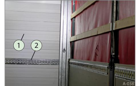
**Abb. 43** Kombi-Ankerschiene stirnseitig
