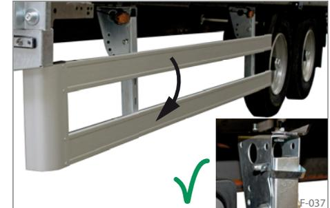
Abb. 39 abgeklappt + gesichert
