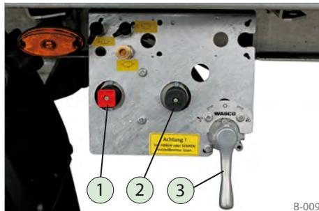
**Abb. 11** Feststellbremse betätigen
