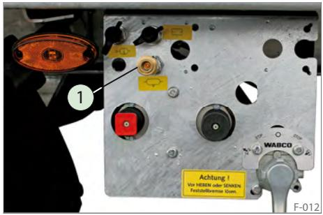
**Abb. 13** Luftanschluss für Druckluftsystem
