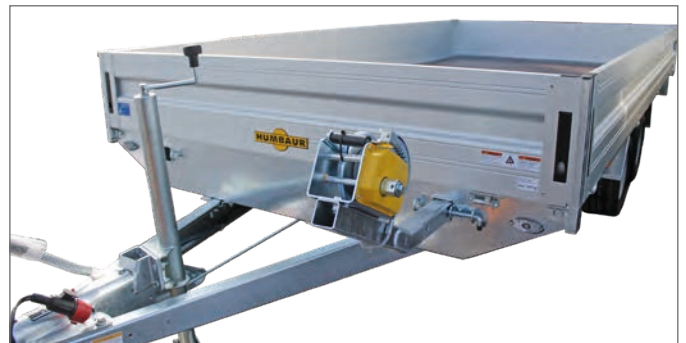
HN avec chevalet de treuil, vue de l'avant
