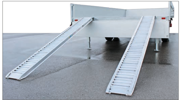
Rampes de chargement positionnées
