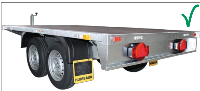
Déplacement en équipement « plateau » (ridelles / montants d'angle démontés)
