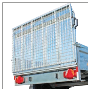
Pont arrière grillagé
