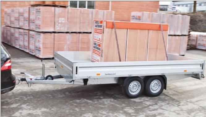
Sécurisé par arrimage au sol
