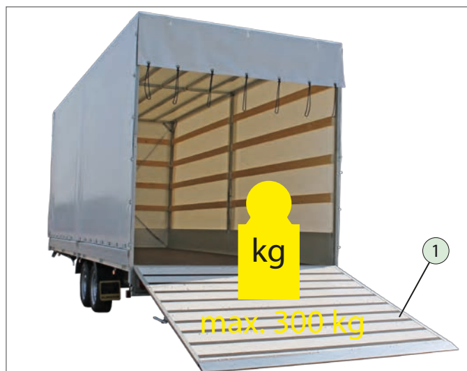
Pont arrière abaissé
