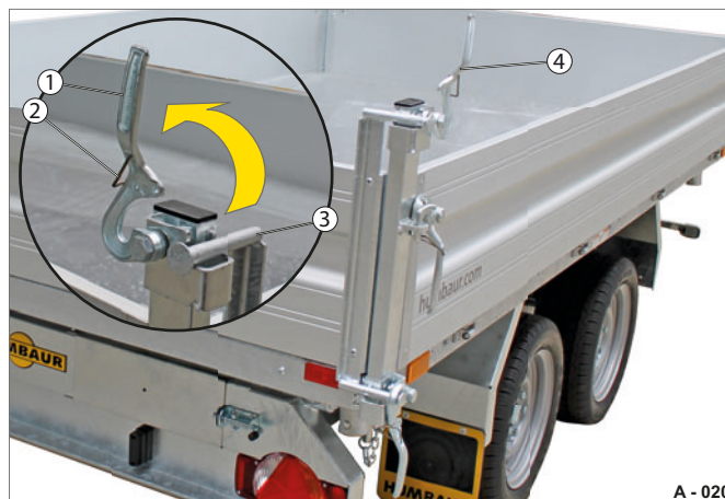
Fig. 18 Déverrouillage de la ridelle arrière en haut
