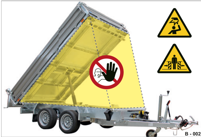
Fig. 6 Surface de chargement basculée vers l'arrière / zone à risque
