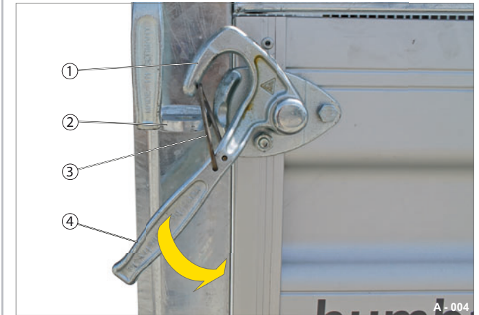
Fig. 7 Verrouillage de la fermeture à levier coudé
