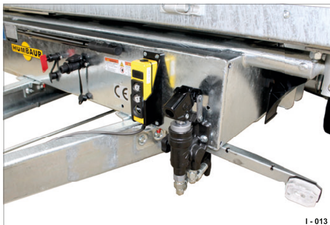
Fig. 25 Unité de commande à boutons-poussoirs et pompe à main d'urgence
