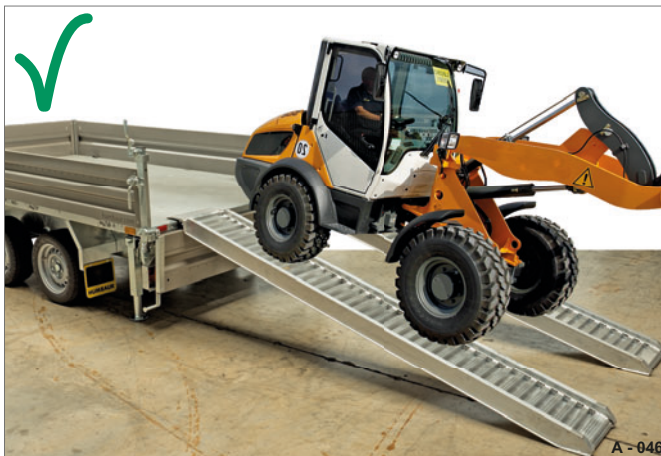
Fig. 101 Montée des rampes de chargement
