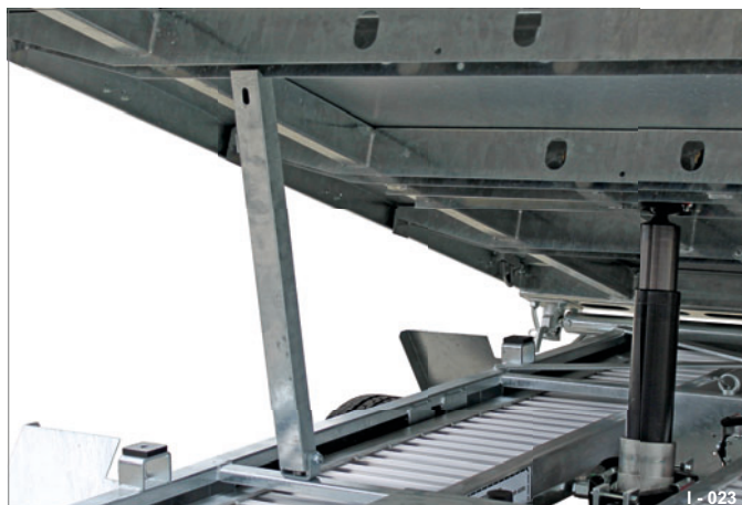
Fig. 26 Béquille de maintenance servant de sécurité pour pont de chargement
