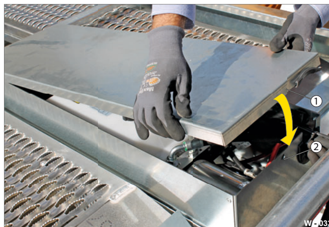
Fig. 27 Montage de la batterie d'alimentation
