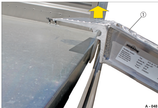
Fig. 103 Rampe de chargement soulevée
