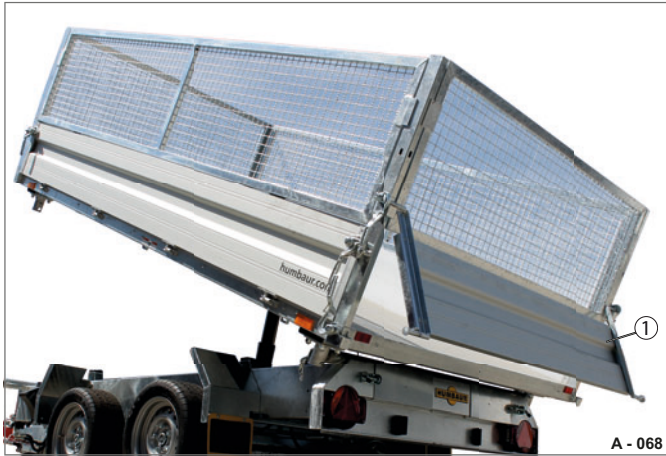
Fig. 44 Basculement vers l'arrière 1 Ridelle arrière, mode d'oscillation
