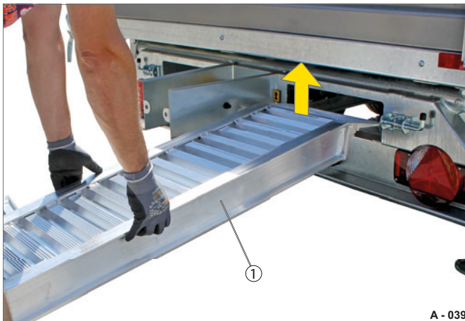
Fig. 90 Soulèvement des rampes de chargement
