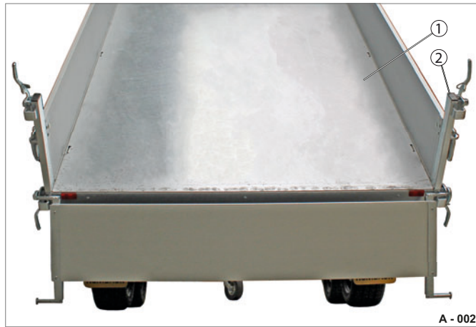
Fig. 2 Composants de la structure (modèle en alu)
