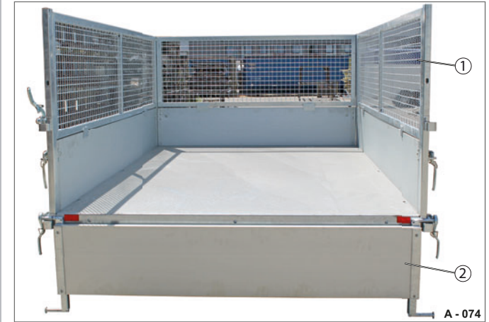
Fig. 58 Rehausse grillagée en acier arrière démontée
