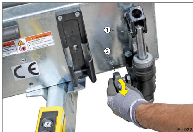
Fig. 20 Fermeture de la pompe à main d'urgence
