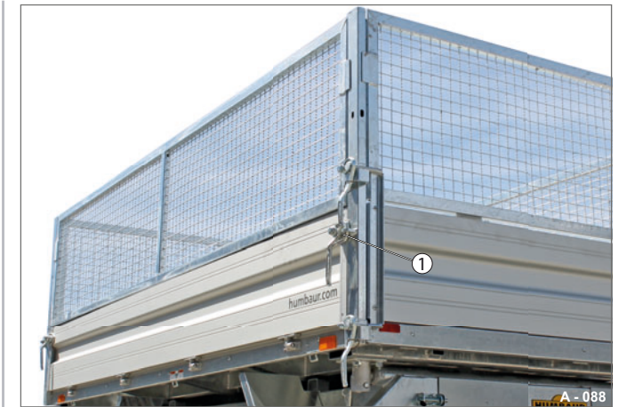
Fig. 40 Rehausse grillagée en acier fermée
