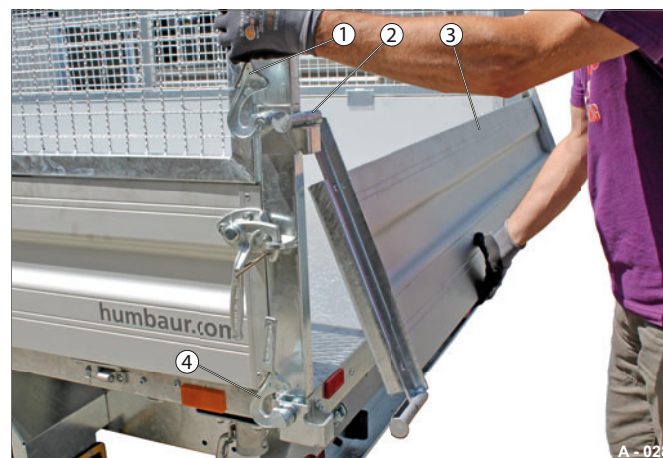
Fig. 26 Démontage de la ridelle arrière
