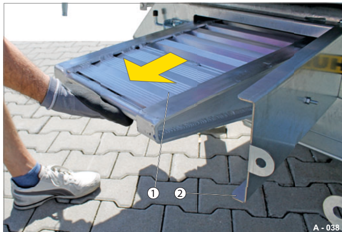
Fig. 89 Enlèvement des rampes de chargement
