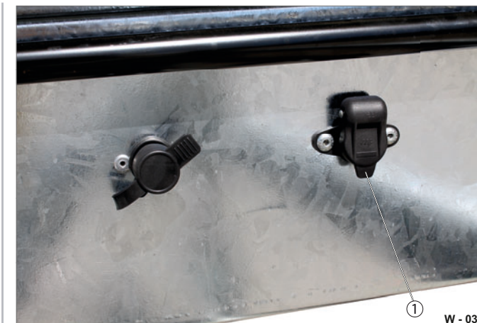
Fig. 30 Raccordement du connecteur de charge de la batterie
