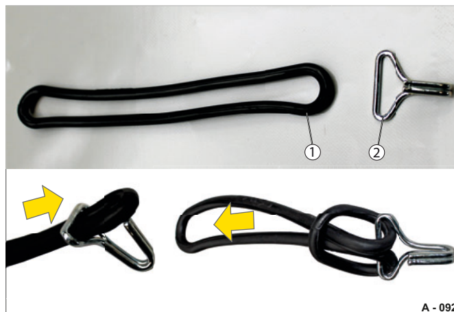
Fig. 74 Préparation du câble tendeur avec les crochets
