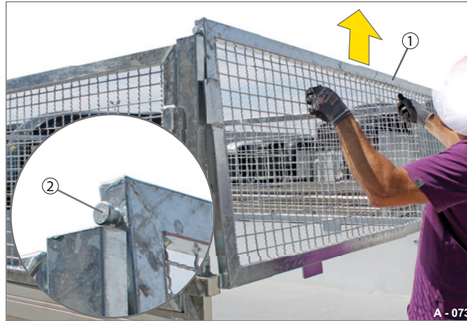
Fig. 57 Démontage de la rehausse grillagée en acier
