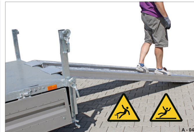
Fig. 102 Franchissement des rampes
