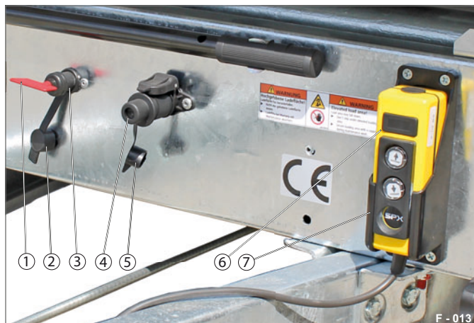
Fig. 14 Poste de commande du système hydroélectrique
