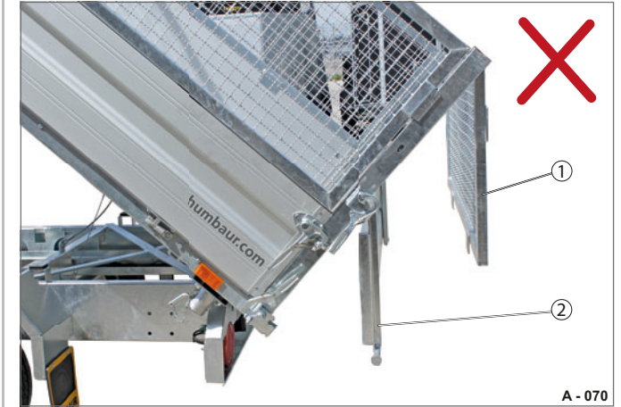
Fig. 46 Rehausse grillagée en acier non bloquée 1 Rehausse grillagée en acier, arrière 2 Ridelle arrière
