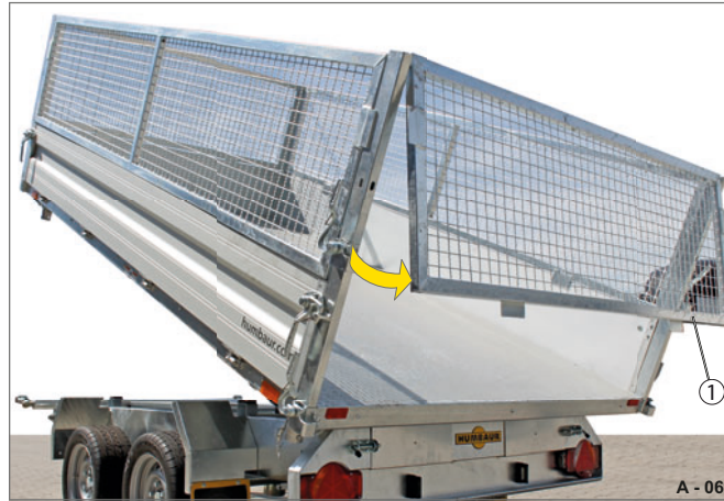
Fig. 45 Rehausse grillagée en acier oscillant librement 1 Rehausse grillagée en acier, arrière
