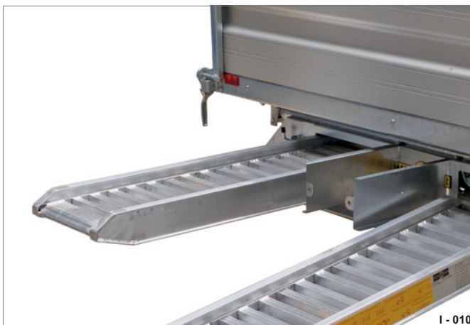
Fig. 15 Rampes de chargement
