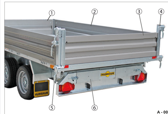
Fig. 1 Composants de la structure (modèle en acier)
