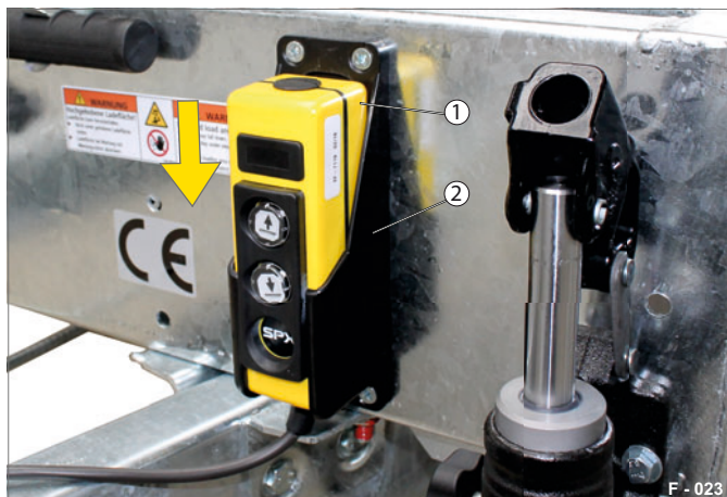
Fig. 23 Mise en place de l'unité de commande à boutons-poussoirs
