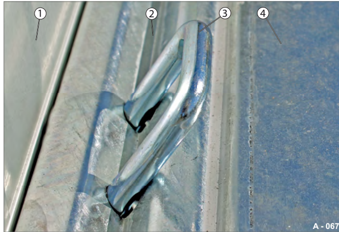
Fig. 74 Étrier d'arrimage (standard), 400 daN (kg)
