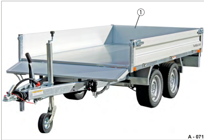
Fig. 18 Fonction de chargement en longueur : Ridelle arrière fermée
