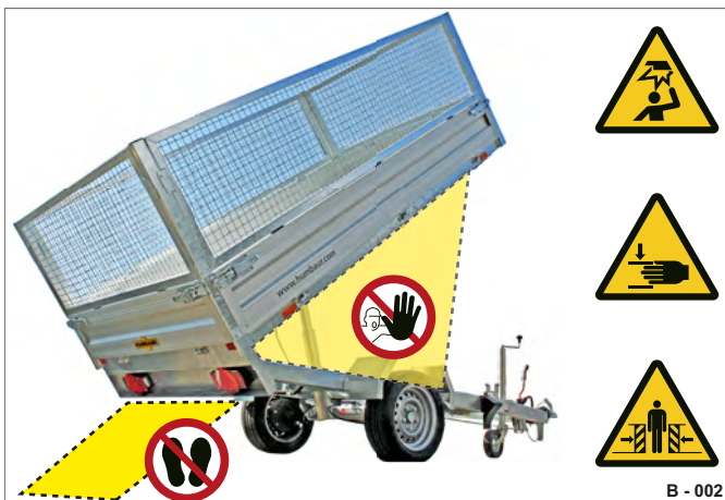
Fig. 2 Surface de chargement basculée vers l'arrière / zone à risque
