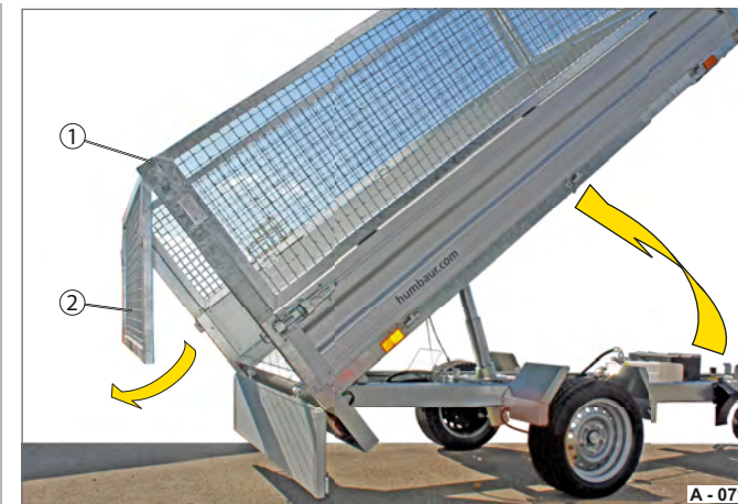
Fig. 47 Mode d'oscillation de la rehausse grillagée en acier
