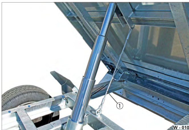
Fig. 13 Mécanique de sécurité sur l'installation hydraulique manuelle
