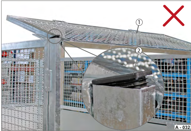
Fig. 48 Rehausse grillagée en acier basculée, mauvais exemple
