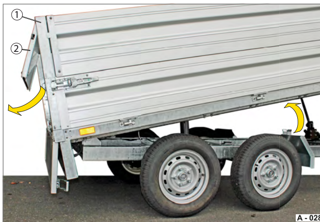
Fig. 46 Mode d'oscillation de la rehausse de ridelles
