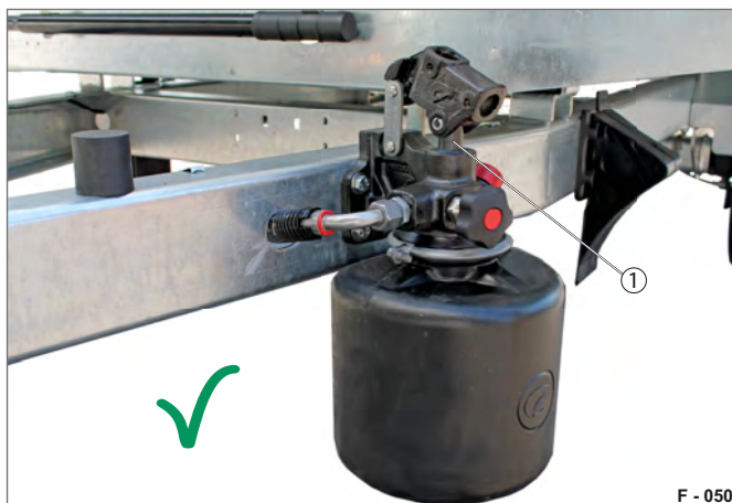
Fig. 11 Pompe à main manuelle en position de conduite
