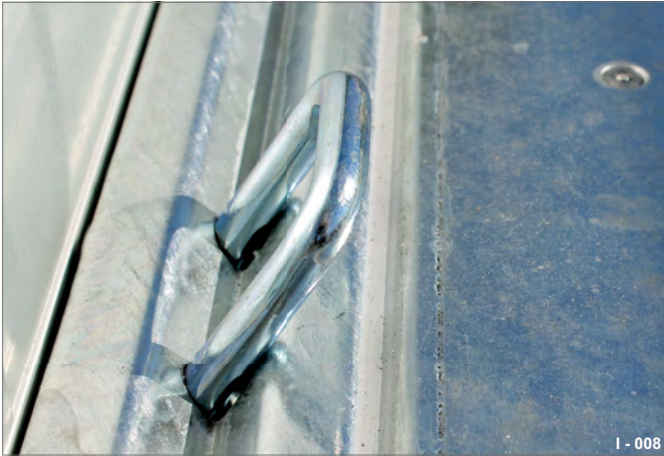
Fig. 8 Étrier d'arrimage, escamotable
