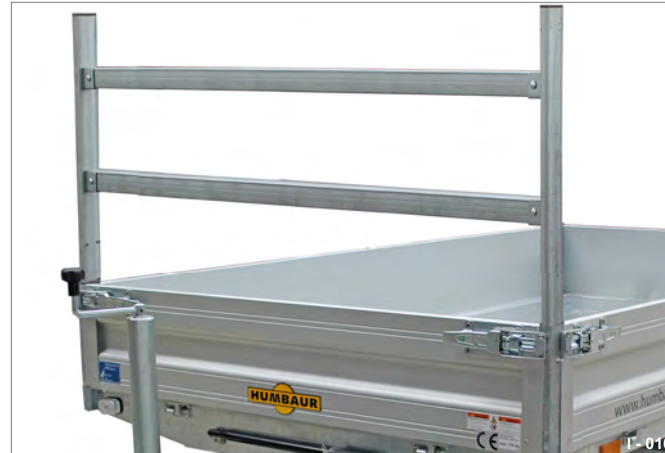
Fig. 16 Sécurisé au niveau de la ridelle frontale, dans les montants d'angle
