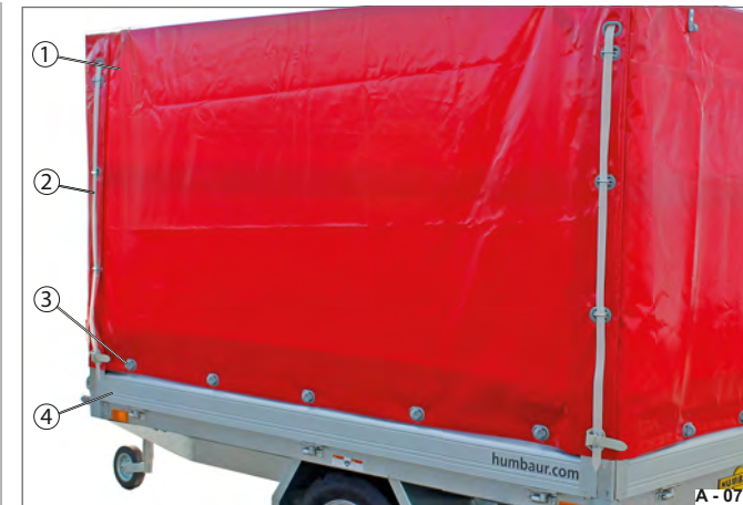
Fig. 68 Bâche haute, bloquée (position de conduite)
