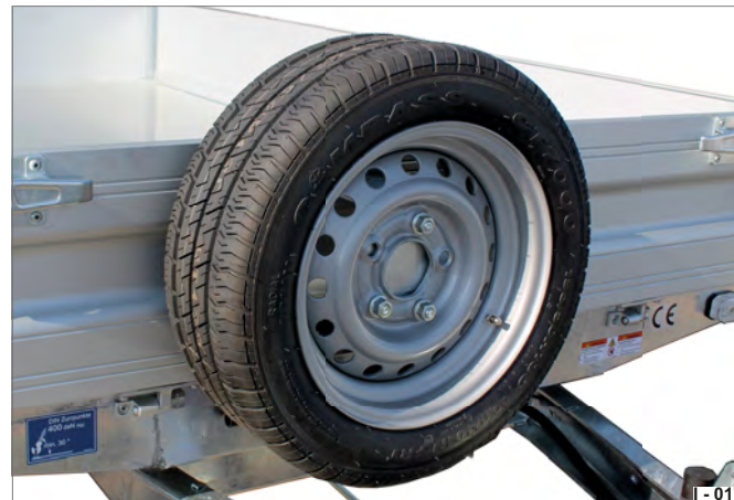
Fig. 17 Roue de secours / support pour roue de secours sur la ridelle latérale
