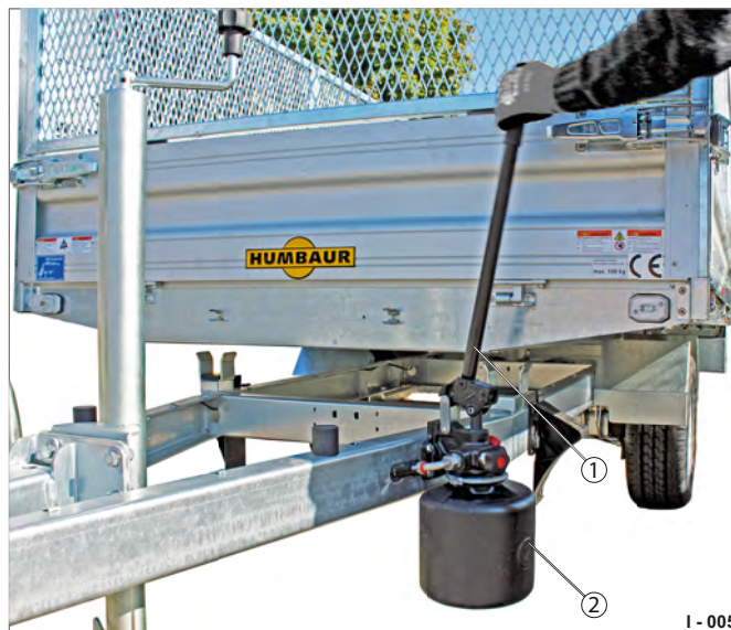
Fig. 5 Pompe à main manuelle
