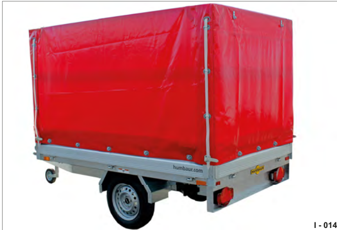
Fig. 14 Bâche haute d'une hauteur de 1 300 / 1 600 mm
