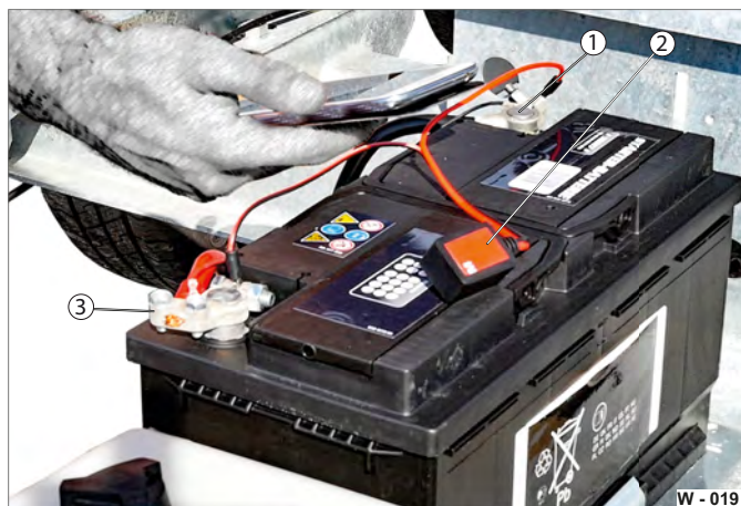
Fig. 24 Chargement / contrôle de la batterie d'alimentation
