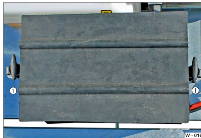
Fig. 19 Batterie d'alimentation recouverte (position de conduite)
