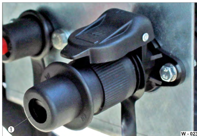
Fig. 27 Connecteur de charge de batterie, enfiché
