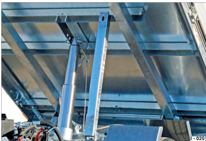
Fig. 20 Béquille de maintenance servant de sécurité pour pont de chargement
