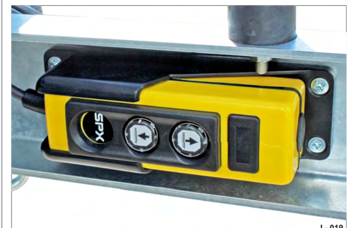
Fig. 19 Unité de commande à boutons-poussoirs dans son support
