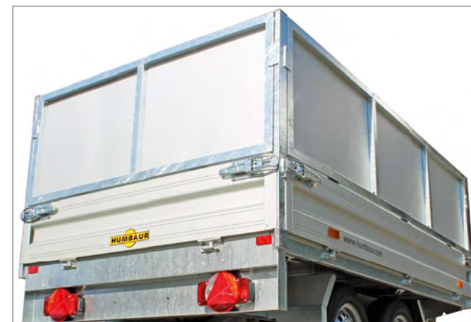
Fig. 44 Rehausse en aluminium, position de conduite
