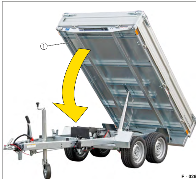
Fig. 35 Pont de chargement basculé en position initiale
