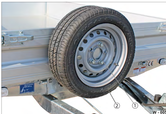
Fig. 5 Contrôle de la fixation de la roue de secours
