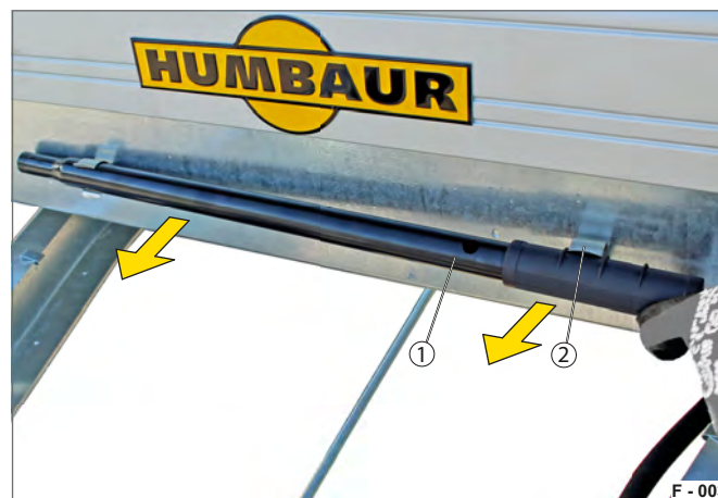
Fig. 2 Retrait du levier de pompe en cas de dispositif de fixation par serrage
