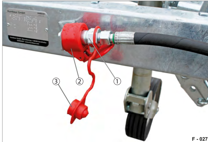
Fig. 29 Raccord hydraulique pour tracteur
