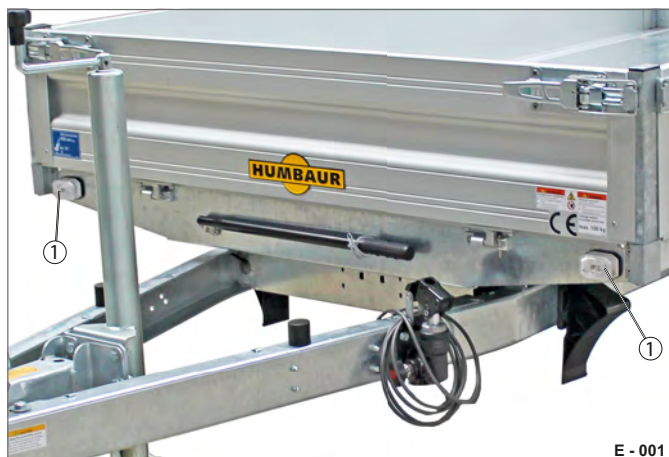
Fig. 1 Éclairage, à l'avant
