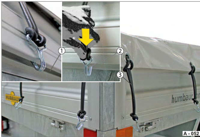
Fig. 59 Déblocage de la bâche plate
