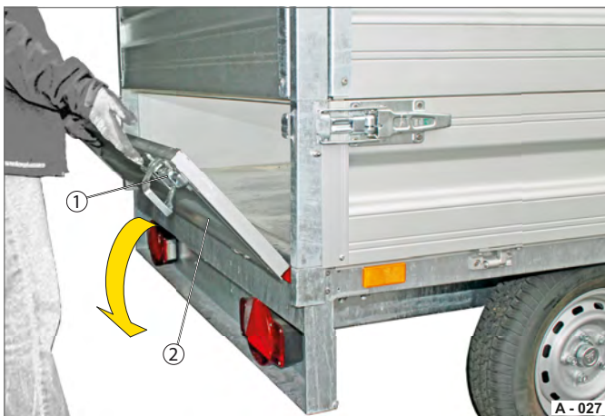
Fig. 45 Ouverture de la ridelle arrière
