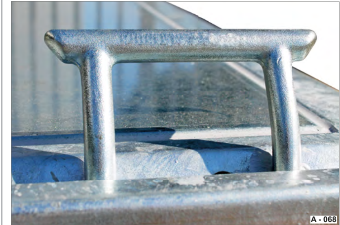
Fig. 76 Étrier d'arrimage (optionnel), 800 daN (kg)
