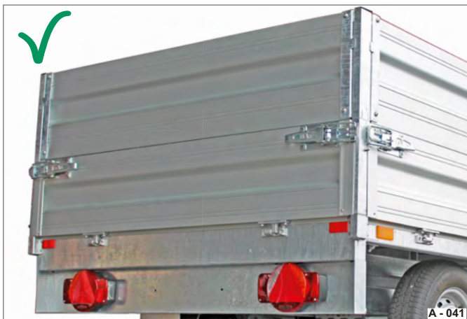
Fig. 42 Ridelle arrière / rehausse de ridelles en position de conduite
