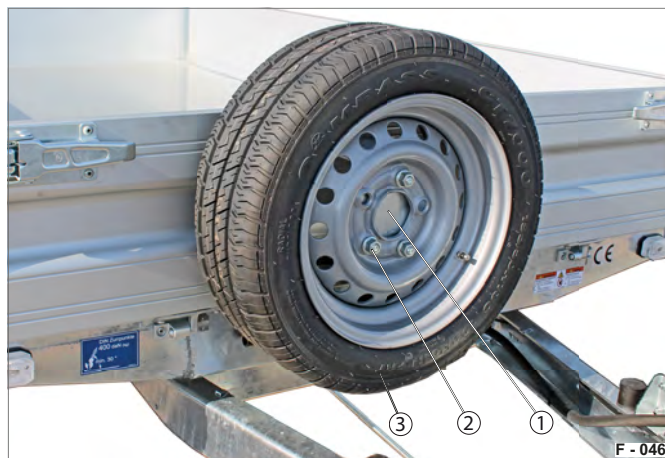
Fig. 44 Support pour roue de secours avec roue de secours
