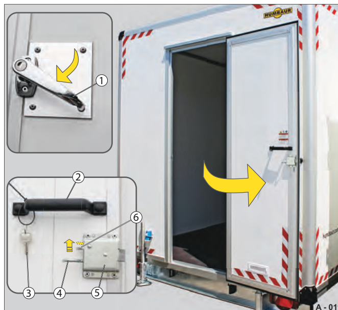
Fig. 2 Access door open
