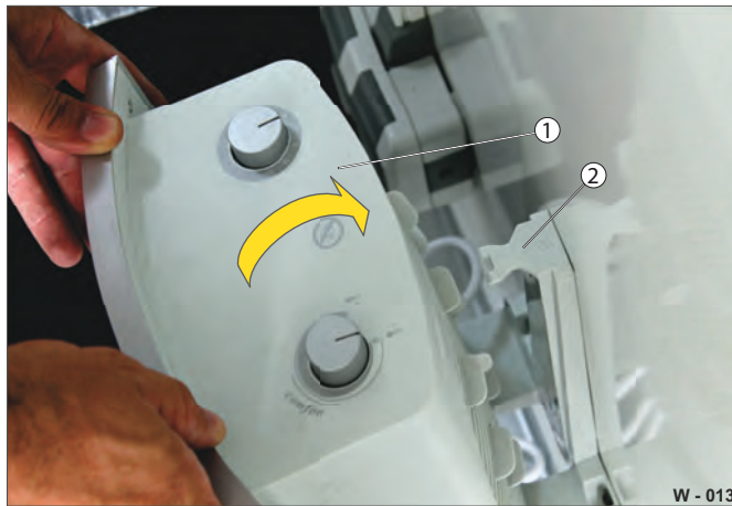
Fig. 8 Clean / check the fan heater
