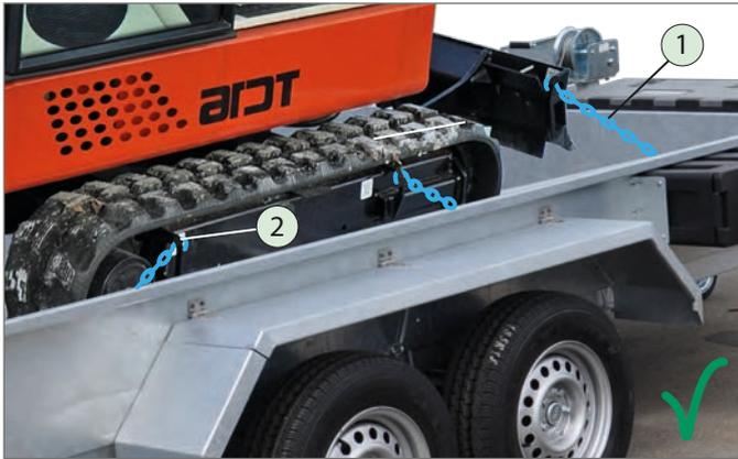
Beispiel „Kraftschlüssige Ladungssicherung“ / Mini-Bagger
