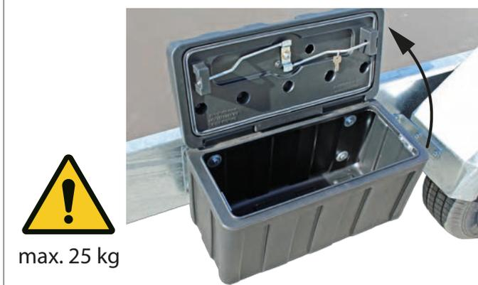
Werkzeugbox entriegelt & geöffnet
