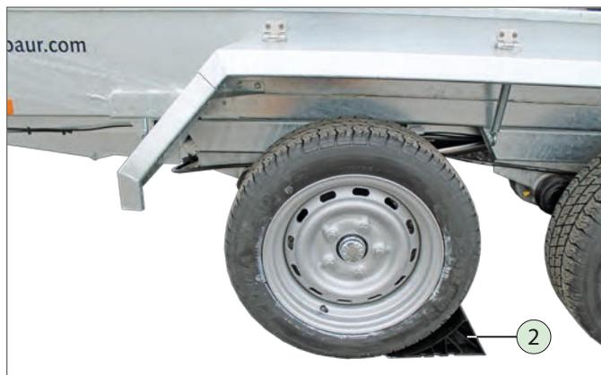
Unterlegkeil an starrer Achse, vorn
