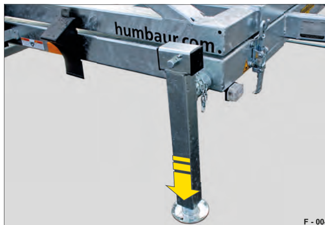
Afb. 4 Telescopische steunpoot in de steunstand
