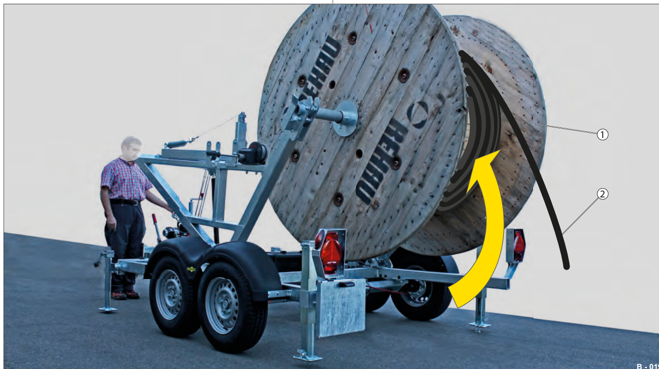
Afb. 16 Haspelframe heffen / kabel bedienen
