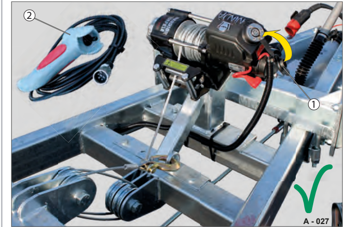
Afb. 18 Elektrische kabellier in de rijstand
