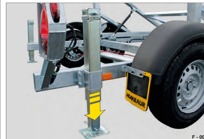
Afb. 6 Telescopische steunpoot in de steunstand
