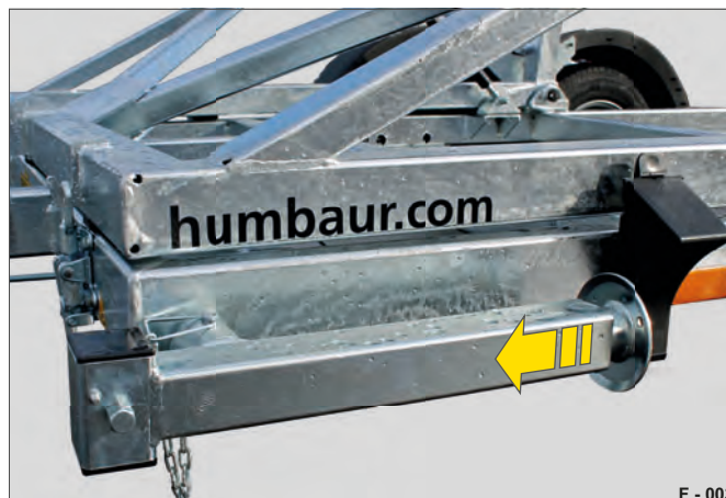
Afb. 3 Telescopische steunpoot in de rijstand
