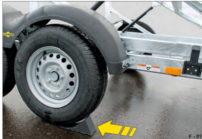
Afb. 10 Wielblokken eronder geplaatst in de parkeerstand
