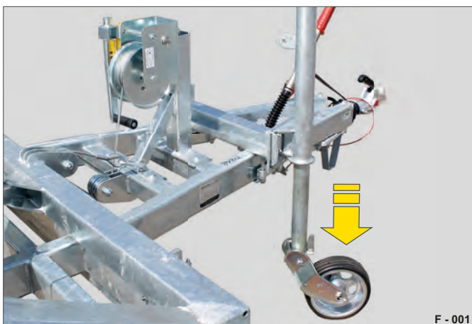
Afb. 2 Automatisch steunwiel in de steunstand
